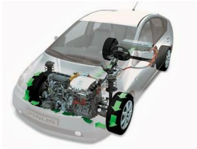
Ilustración 16: Esquema de frenado regenerativo de Toyota Prius
