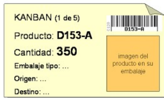
Ilustración 5. Tarjeta Kanban en una estación de una línea de producción
