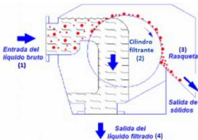
Figura 19 Esquema del funcionamiento de un tamiz rotativo. Fuente: [GEDARX]
