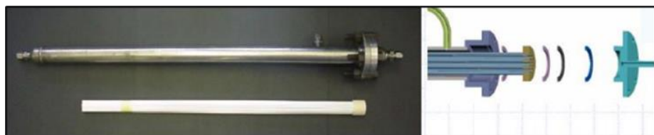
Figura 21: Componente de la membrana cerámica. [12].
