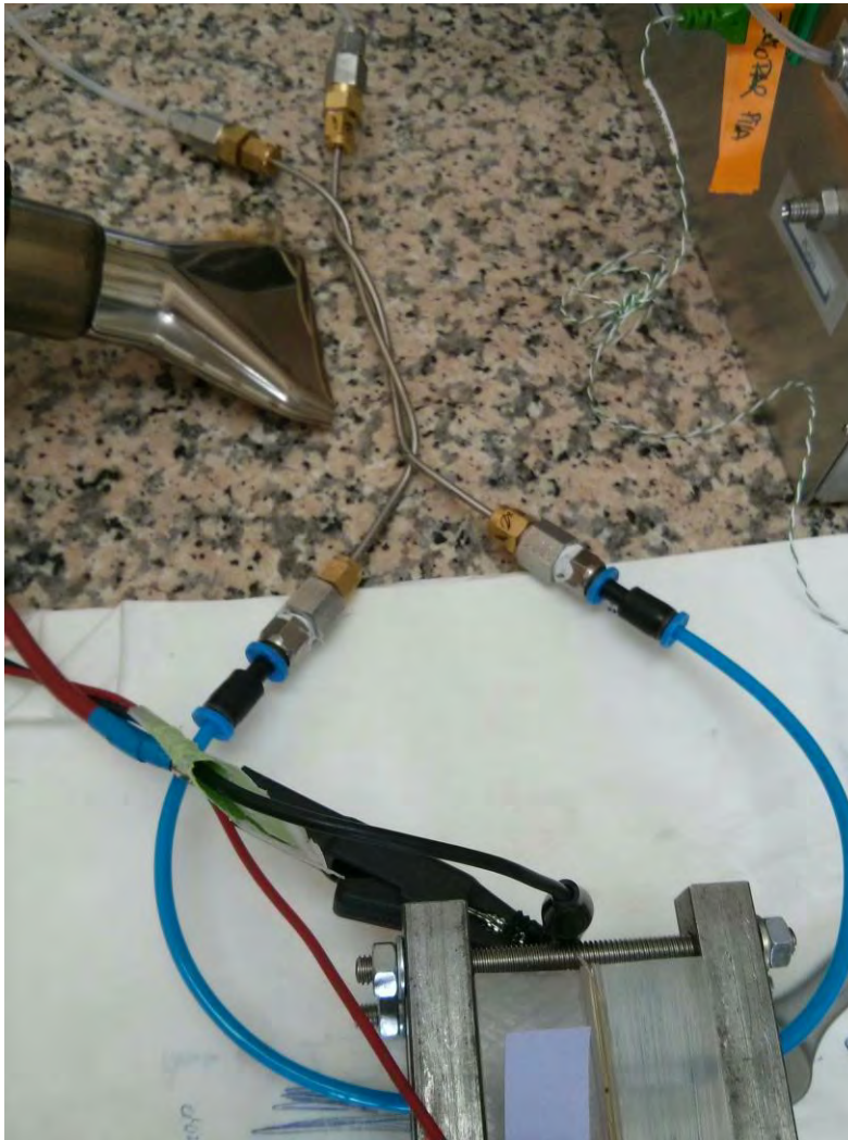
Figura 6.25: Método de calentamiento de la pila a través del gas con pistola de calor y tubos metálicos.
