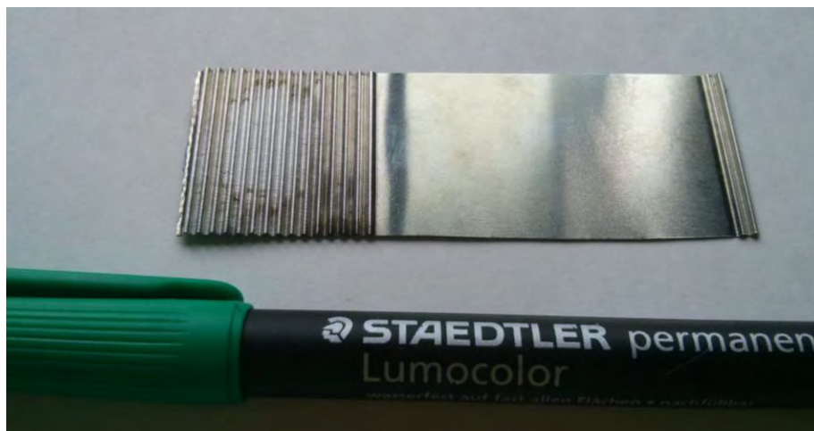
Figura 5.2: Placas bipolares integradas en las pilas analizadas (Patente 1 CSIC)
