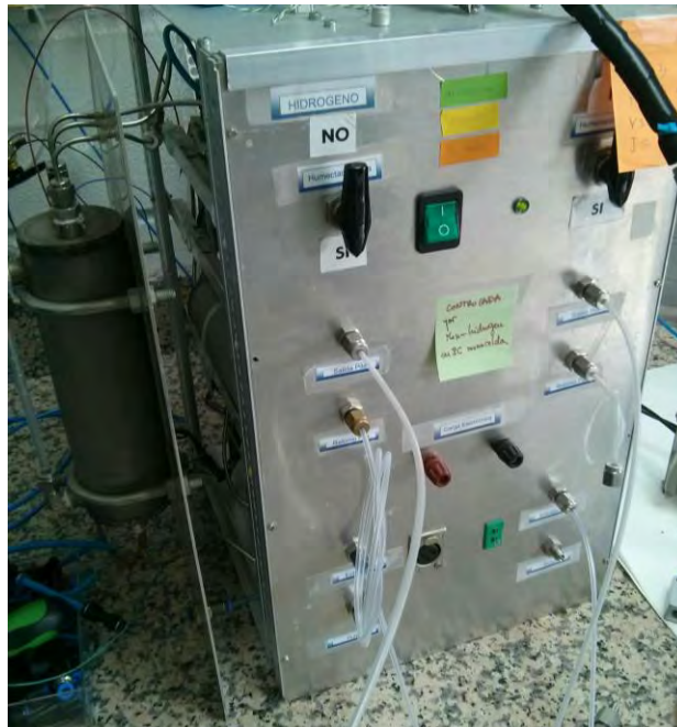
Figura 6.1: Estación de alimentación y control de gases para ensayos de pilas de combustible.
