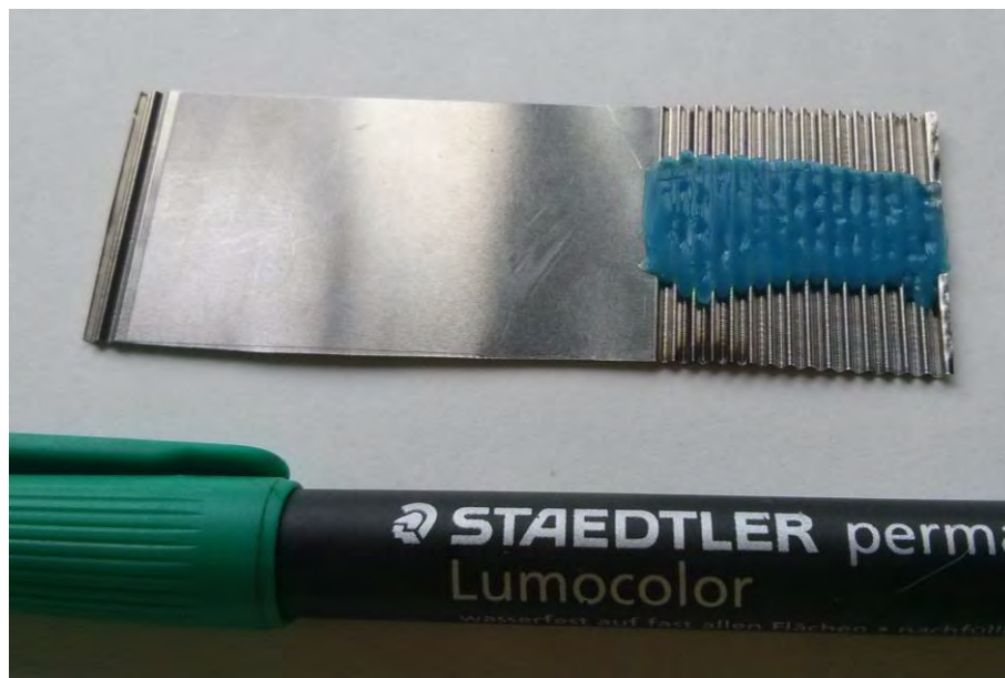
Figura 5.9: Placa bipolar con sellado trasero.
