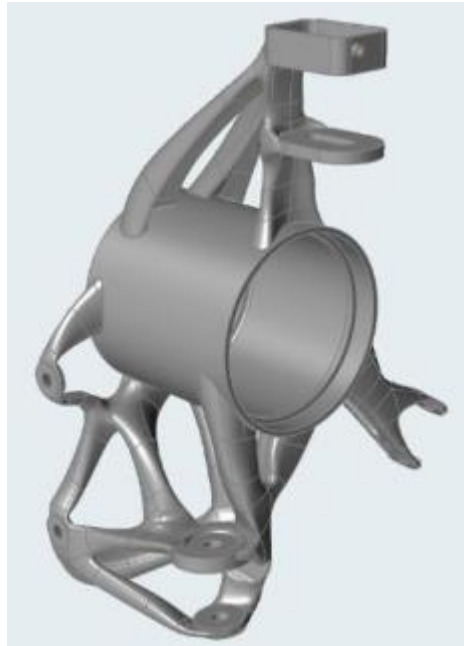
Figura 10. Resultado de la optimización topológica de la mangueta. Fuente Hunar et al. [17]
