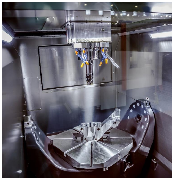
Figura 1. Ejemplo de máquina CNC de cinco ejes para fabricación de moldes de inyección. Fuente: matriceriapastor.com
