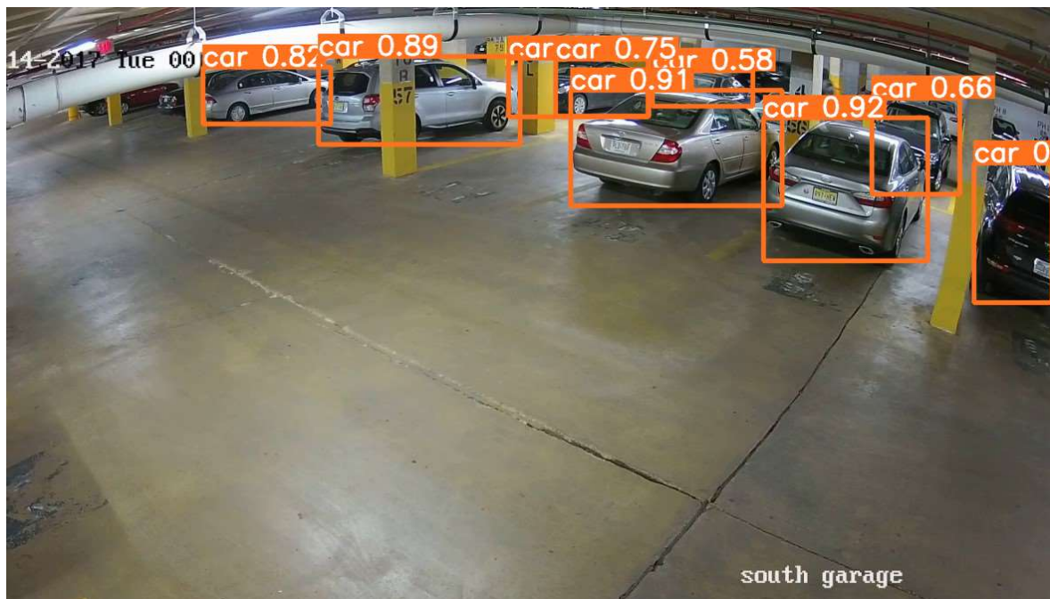
Figura 5: Detección de vehículos con YOLOv8 en aparcamiento cubierto
