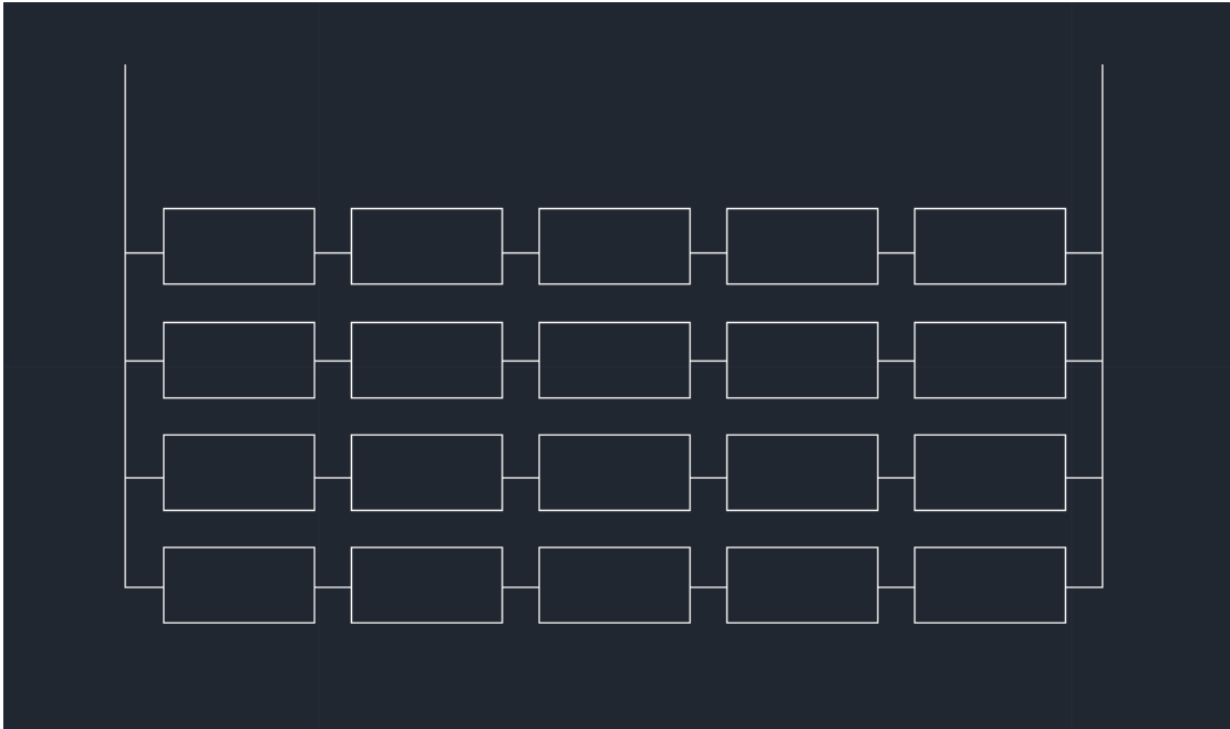
Figura 4. Diagrama de la disposición ejemplo de los módulos FV
