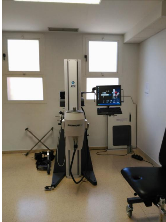
Figura 2. Dinamómetro isocinético BTE-PRIMUS RS. Imagen propia.
