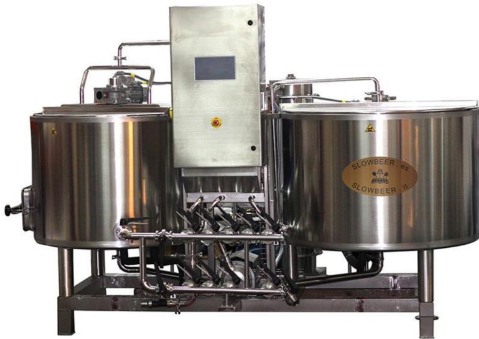
Figura 9. Sistema completo de elaboración del mosto
