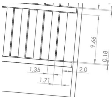
Ilustración 3-15: Plano de las medidas de separación entre paneles.
