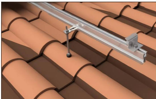
Ilustración 2-10: Ejemplo de estructura de soporte para cubiertas inclinadas con varilla roscada.
