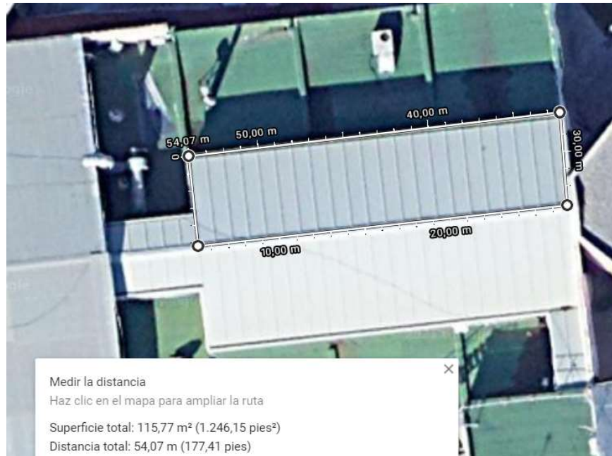
Figura 54. Superficie disponible sobre uno de los faldones de la cubierta del comedor.
