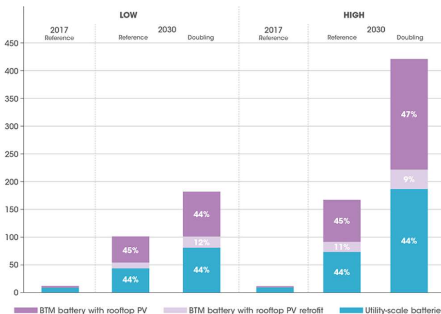
Figura 41. Crecimiento en el almacenamiento de energía eléctrica para 2030[18].
