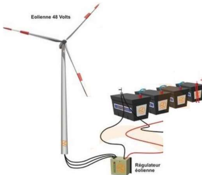
Figura 73. Esquema de conexión del regulador de carga.
