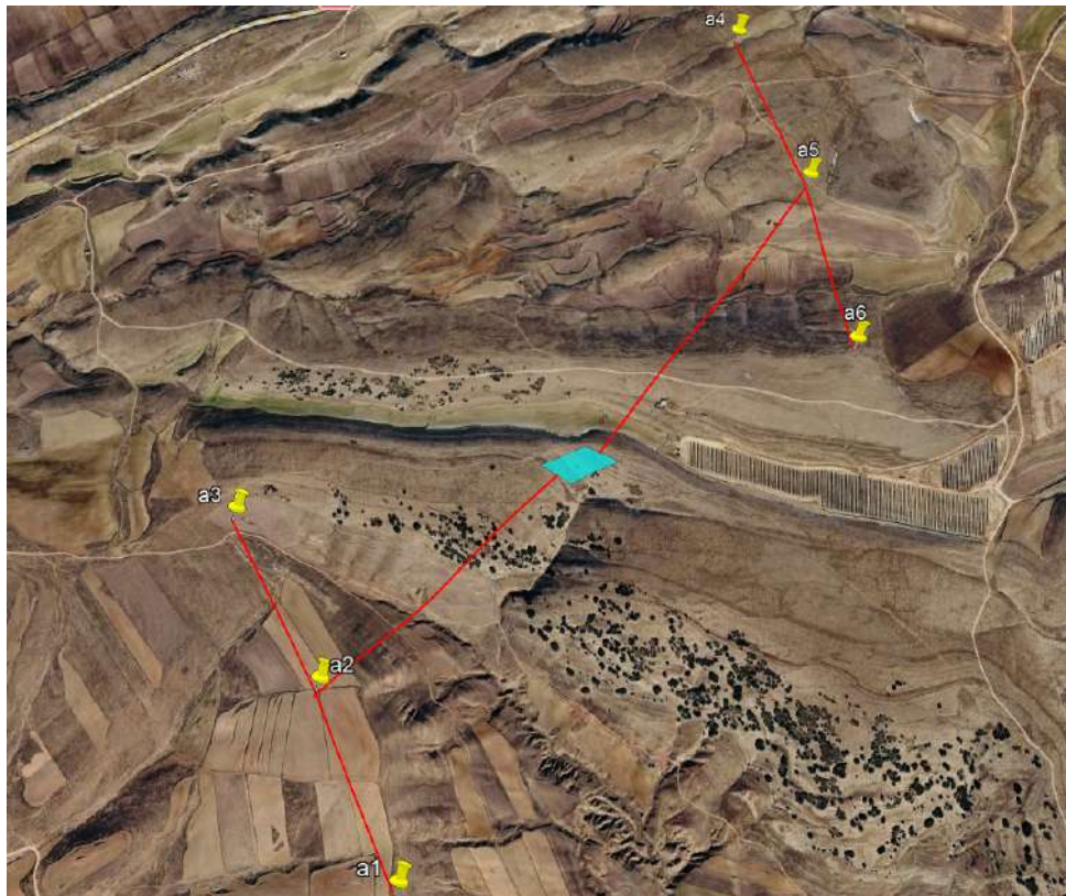
Ilustración 28: Tramos de las zanjas eléctricas
