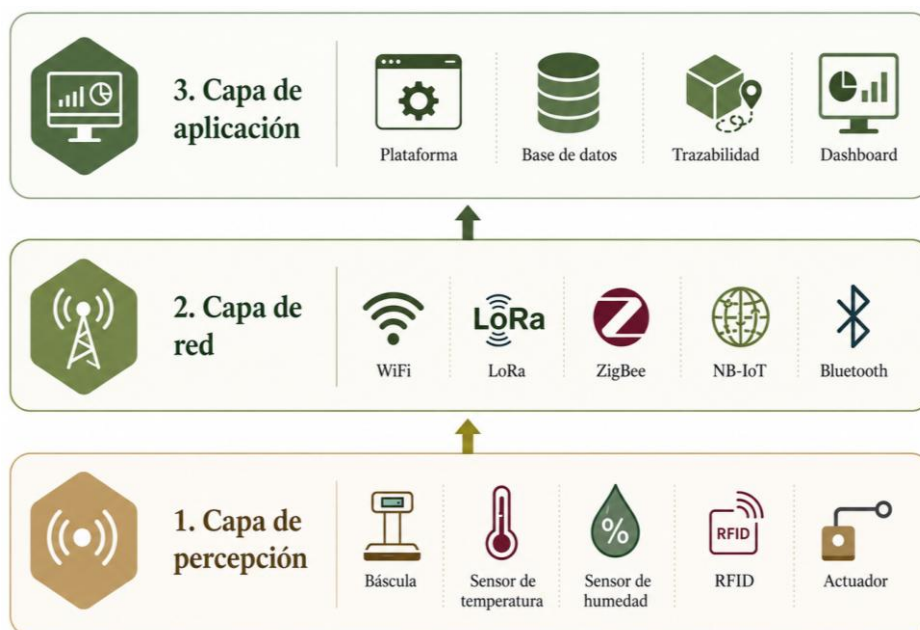
Figura 1. Arquitectura típica de un sistema IoT aplicado a la trazabilidad
