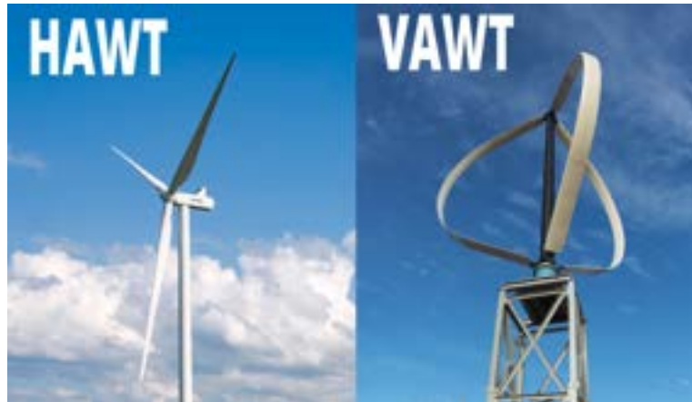
Figura 4.2: Comparativa entre aerogenerador de eje vertical (VAWT) y de eje horizontal (HAWT).
