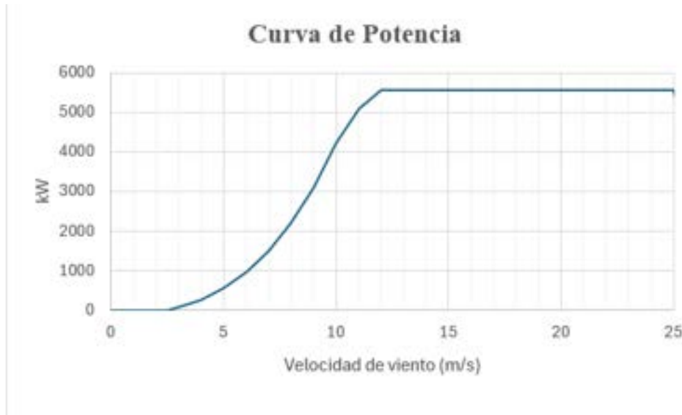
Figura 7.2: Curva de potencia del Enercon E-160 EP5.
