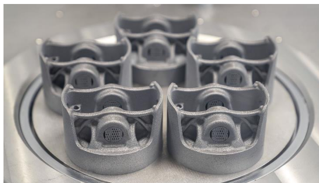
Ilustración 22 Pistones del motor 911 GT2 RS impresos por fabricación aditiva.
