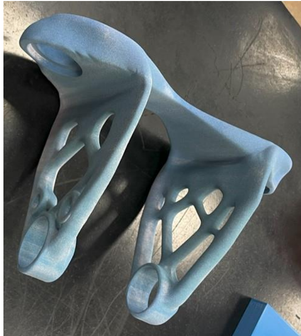
Ilustración 127 Soporte optimizado refinado tras ser limpiado
