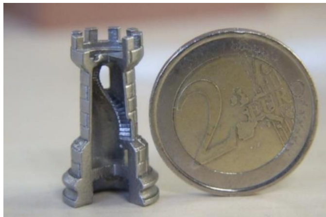
Ilustración 12 Detalle de la complejidad de una pieza del tamaño de una moneda.
