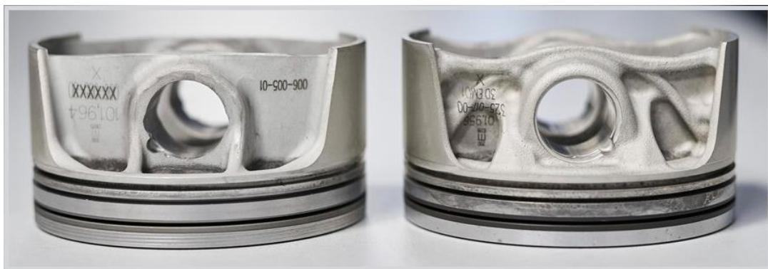
Ilustración 23 Detalle del antes y después de la OT de los pistones
