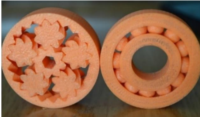
Ilustración 13 Engranaje y rodamiento impresos a través de fabricación aditiva.
