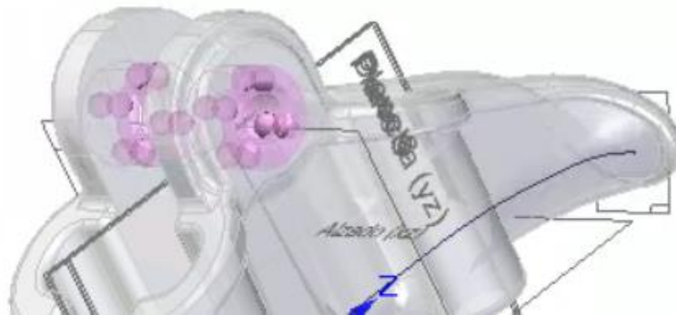
Ilustración 40. Restricción de movimiento del agujero central. Fuente: elaboración propia
