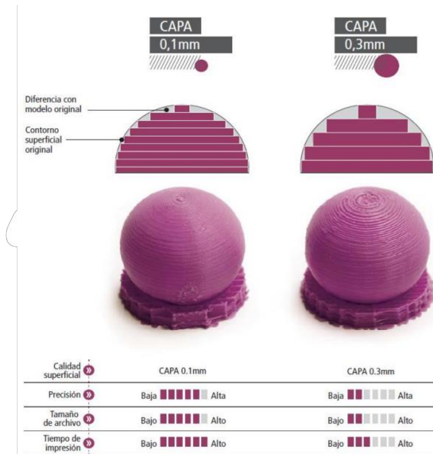
Ilustración 83. Tamaño de capa. Fuente: Temario Tecnologías de Fabricación Comillas ICAI
