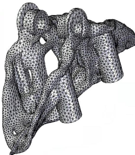
Ilustración 48. Mallado al 50%. Fuente: elaboración propia
