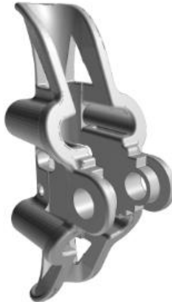
Ilustración 101. Pieza impresa en aluminio. Fuente: elaboración propia
