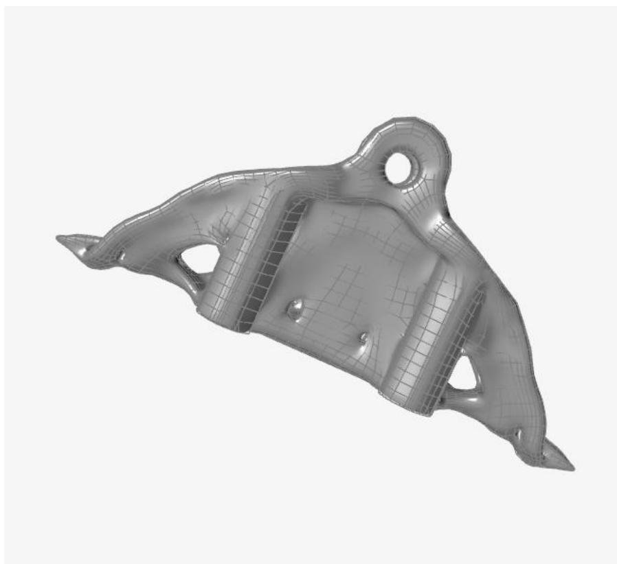
Ilustración 63. Pieza refinada con Altair. Fuente: elaboración propia
