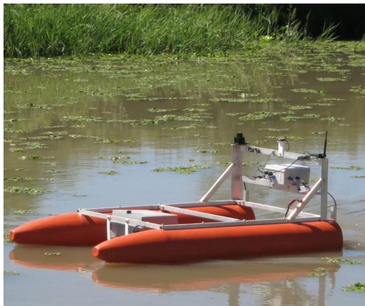
Ilustración 7. Vehículo autónomo de superficie de la UBA[12]
