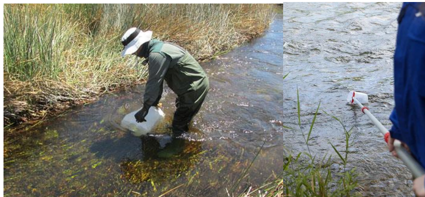
Ilustración 11. Muestreo manual con balde y red manual.[SEGEA, direct industry]
