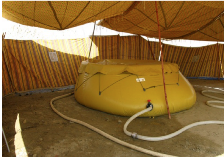
Figura 5: Tanque flexible de Oxfam
