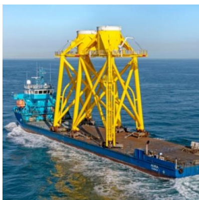
Ilustración 44: Transporte de estructura jacket
