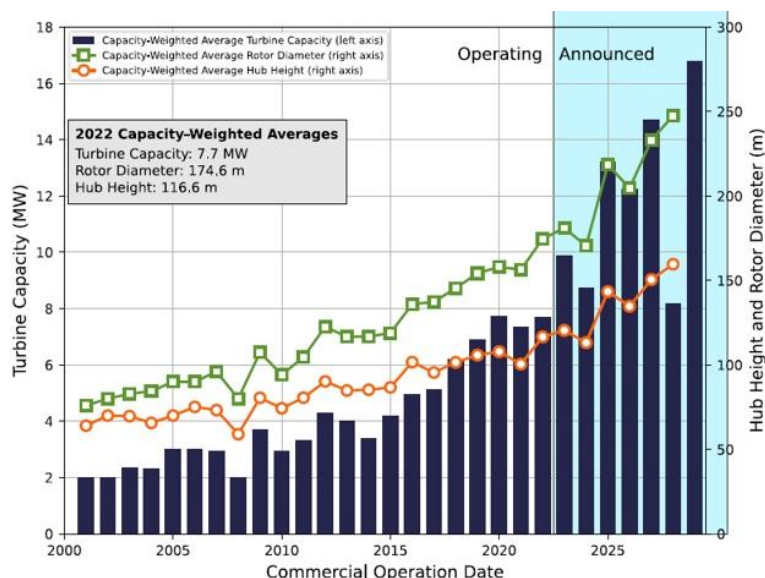
Ilustración 14: Capacidad, diámetro de rotor y altura de buje aerogeneradores marinos (NREL, 23)
