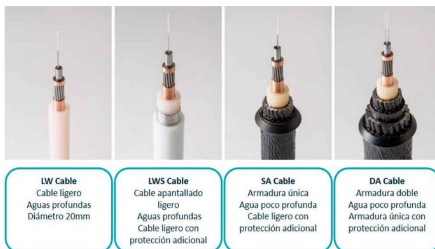
Ilustración 50: Tipos de cable de fibra óptica (NEC, 24)
