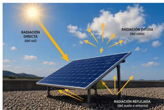
Figura 17. Tipos de radiación solar que inciden en un módulo fotovoltaico
