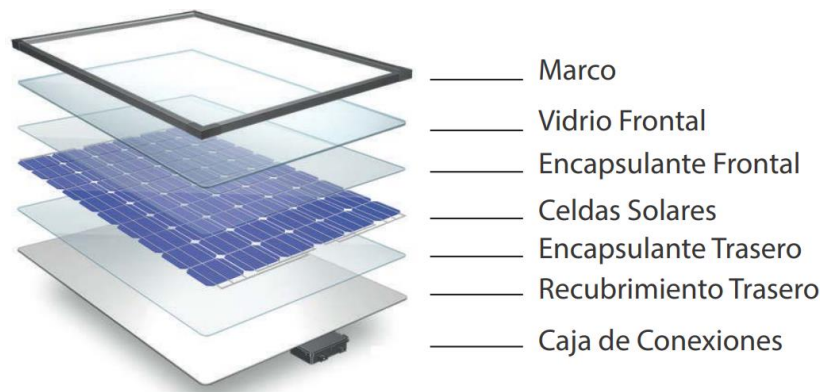
Figura 15. Partes de un panel solar fotovoltaico [12]
