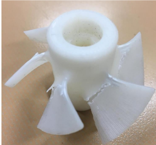
Figura 26: Rodete de la segunda impresión roto por someterlo a caudales de 35\text{m}^3/\text{h} . (Elaboración propia)
