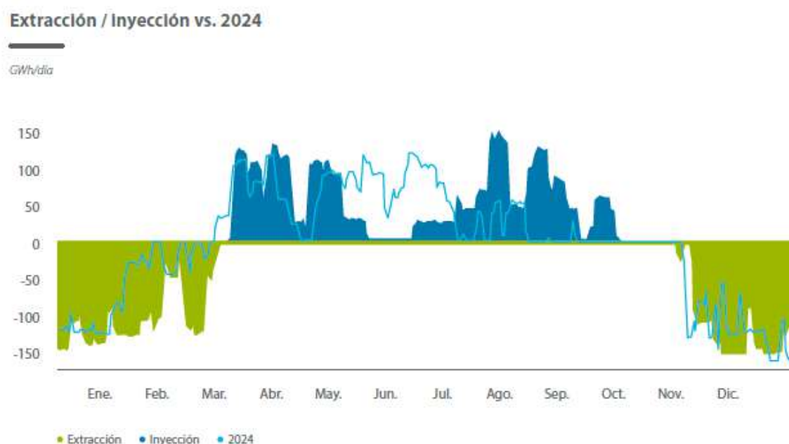
Figura 2.8. Evolución diaria de los flujos de inyección y extracción en los almacenamientos subterráneos en España durante 2025, comparados con 2024.
