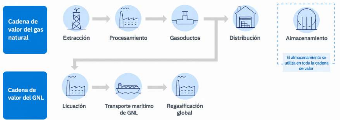
Figura 2.1. Cadena de valor del gas natural y del gas natural licuado. Fuente: elaboración propia.
