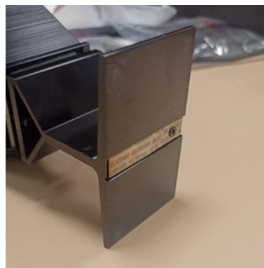
Figura 48: Pata del calentador con lámina de elemento conductor
