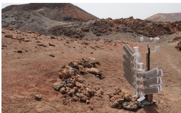
Figura 18: Generador termoelectrónico ubicado en el Parque Nacional de Timanfaya [38]. El prototipo fue diseñado para no requerir mantenimiento, de manera que trabaja automáticamente sin generar ruidos ni ocupar demasiado espacio y sin contaminar el entorno. Este prototipo se
