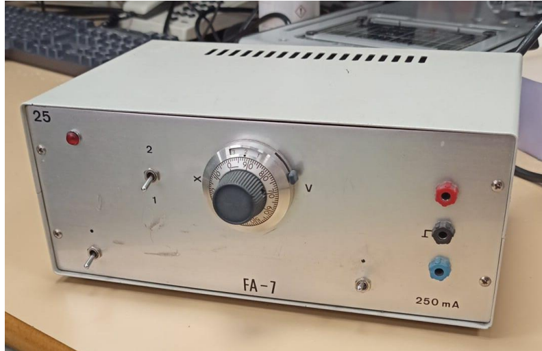
Figura 29: Fuente de alimentación de corriente continua
