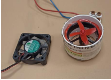
Figura 37: A la izquierda, ventilador industrial de 5 V. A la derecha, ventilador de dron: DC 12V, 0,05 A, 40x40x10mm [61].
