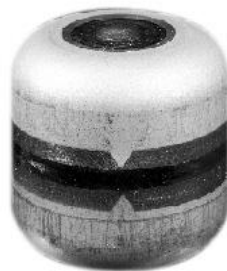
Figura 10: Esfera de combustible de Pu-238 encapsulada y protegida
