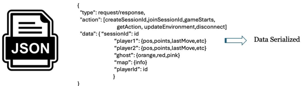
Figura 30. Estructura JSON del protocolo de comunicación entre cliente y servidor. Elaboración propia.
