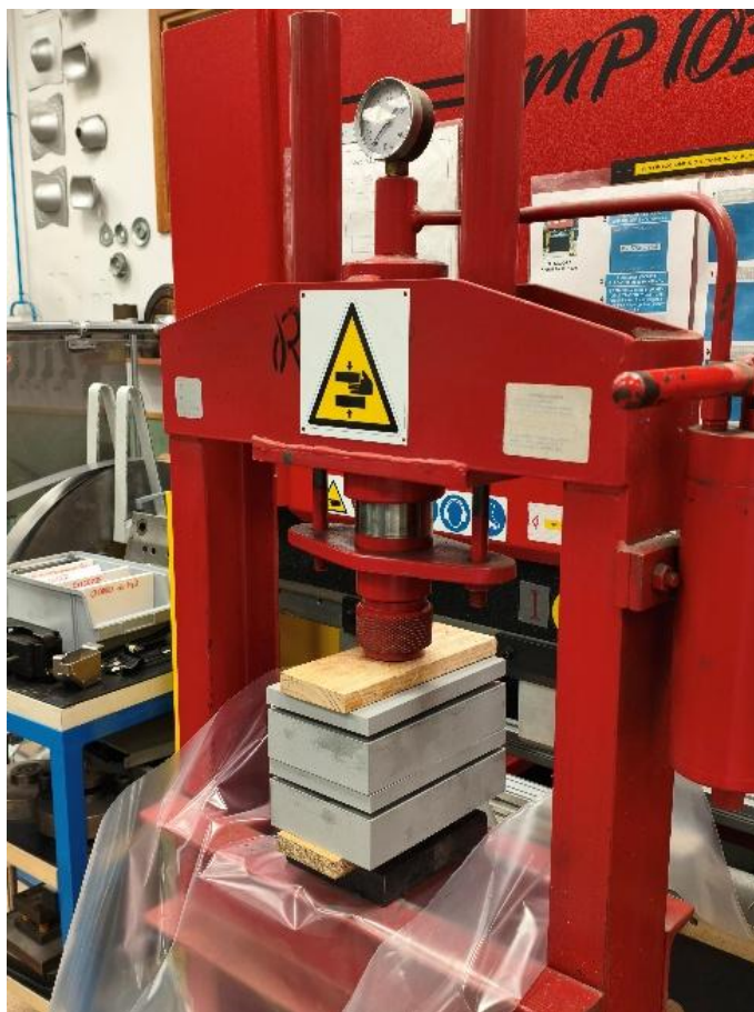
Figura 16. Molde en la prensa hidráulica con tacos de madera para distribución de presión.
