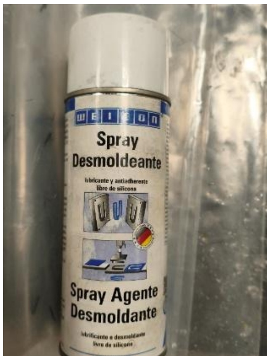
Figura 10. Spray desmoldeante Weicon utilizado para facilitar el desmoldeo.
