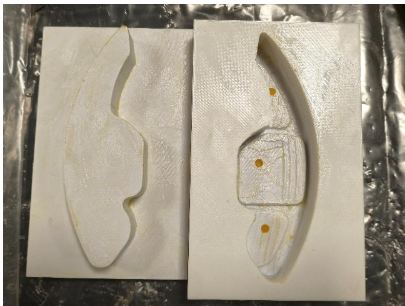
Figura 26. Molde ensayo 4 con cera desmoldante aplicada.
