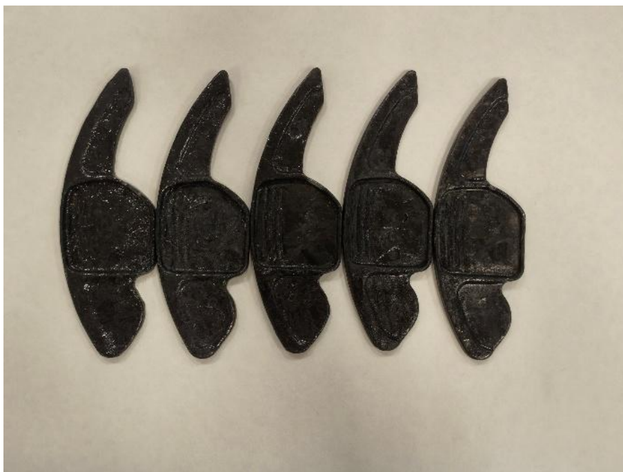
Figura 33. Piezas con capa de clearcoat.
