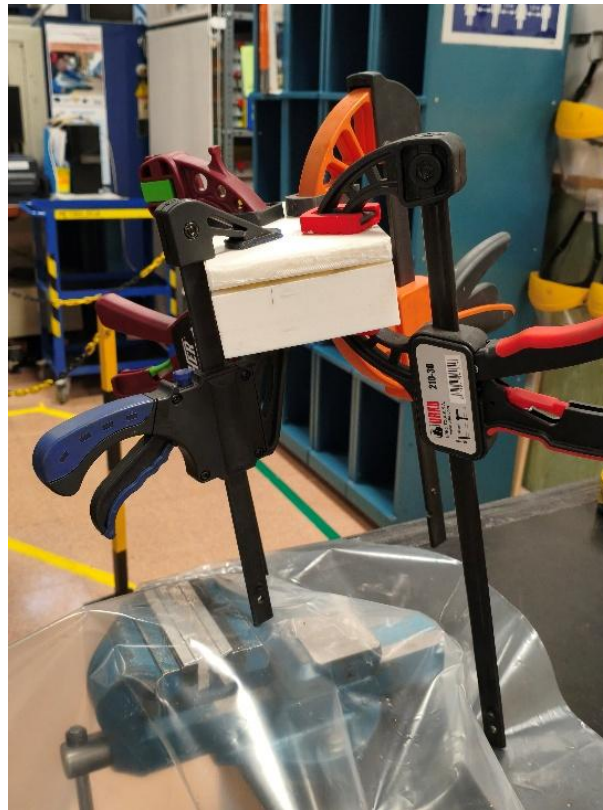
Figura 18. Molde FDM vertical sujeto con gatos de apriete durante el curado.
