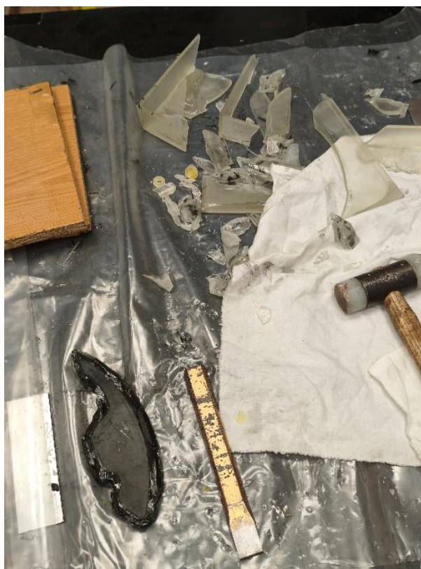
Figura 24. Molde destruido debido a su adherencia con la pieza.
