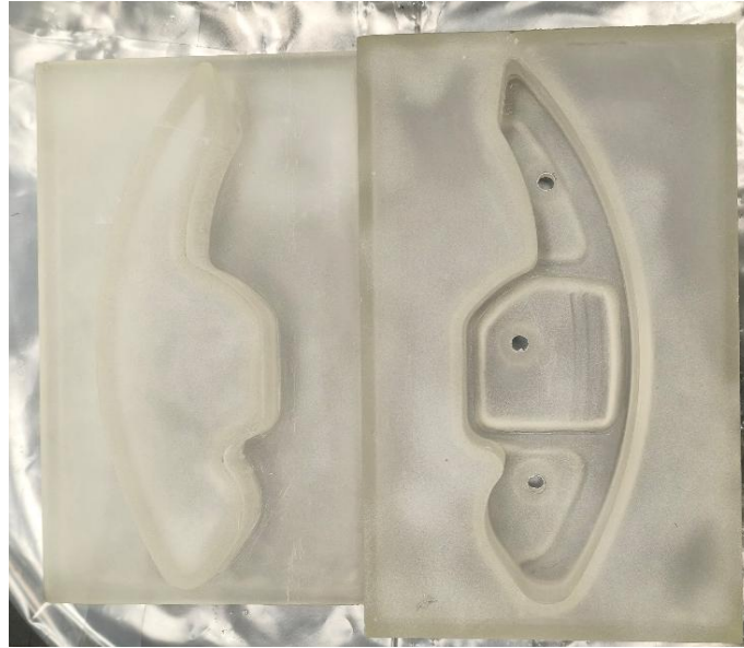
Figura 22. Moldes de resina tras el postprocesado: superficie lisa y translúcida.
