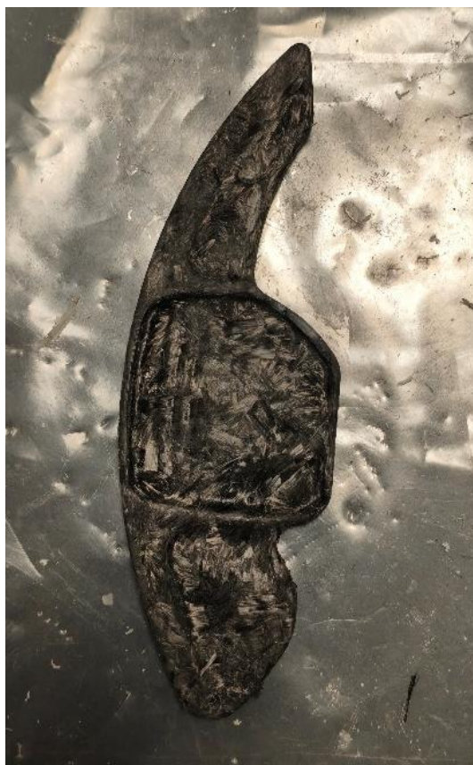
Figura 19. Pieza del Ensayo 2, con defecto de resina curada.
