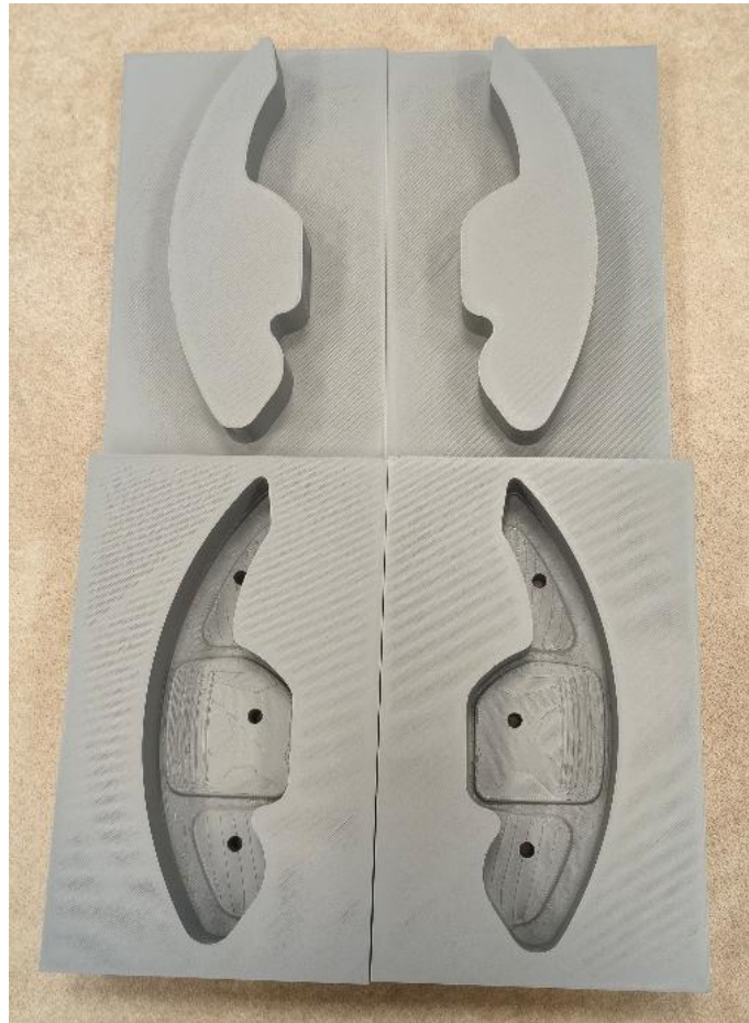
Figura 15. Moldes FDM impresos en horizontal: parte macho (arriba) y hembra (abajo).
