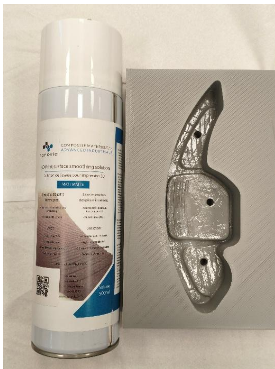
Figura 9. Nivelador de capas aplicado sobre un molde FDM.
