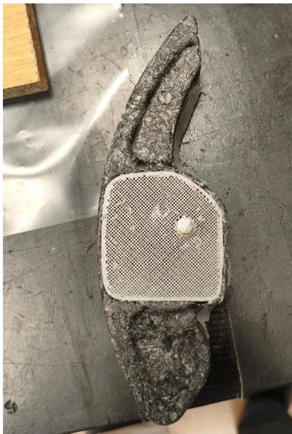
Figura 17. Pieza del Ensayo 1, con exceso de resina curada.
