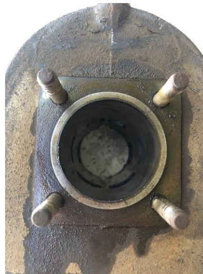
“Detalle camisa del cilindro”
