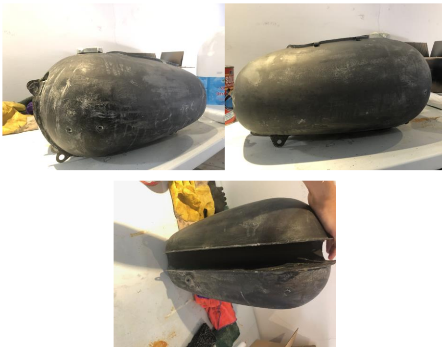
“Vistas depósito desoxidado y desengrasado” imagen 52
