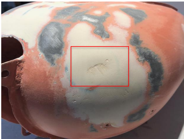
“Defecto falta de masilla” imagen 40
