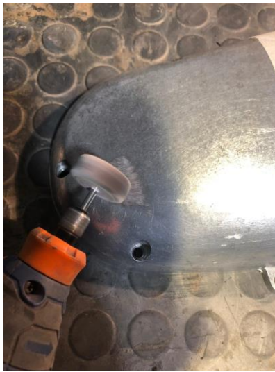
“detalle desbaste lija 80”
