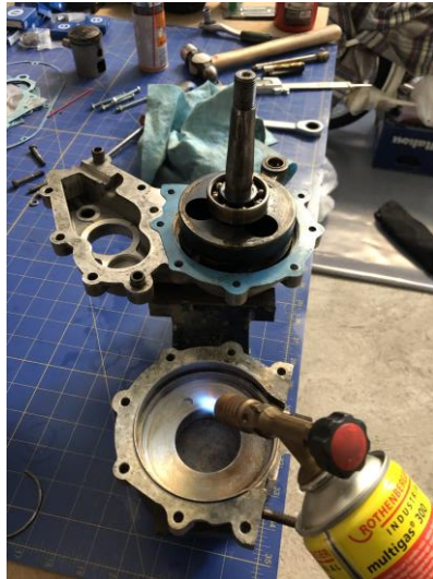
“dilatación con soplete para montaje” imagen 91
