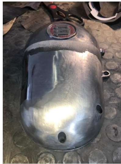
"comparación entre pulido y desbaste" imagen 192
