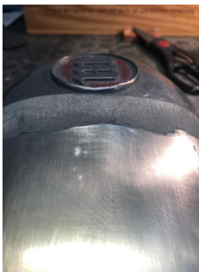
“defecto surcos tras lija 1000” imagen 190
