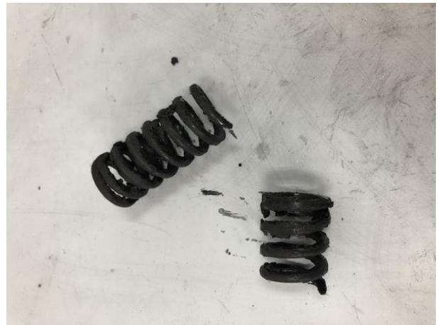
“muelle suspensión trasera fracturada”
