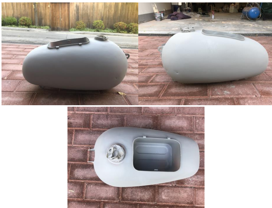
“Vistas depósito imprimación de alta densidad” imagen 57
