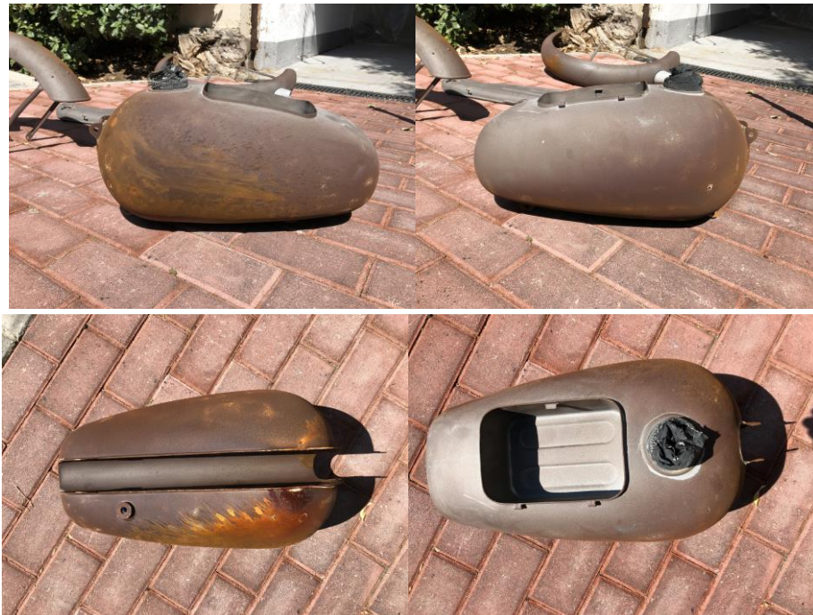
“Vistas depósito arenado” imagen 51
