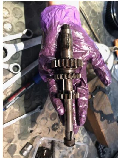
“Detalle engranajes de 1ª 2ª y 3ª velocidad” imagen 77
