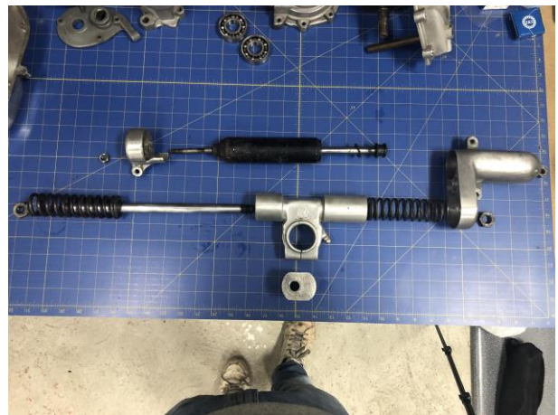
“suspensión trasera desarmada y limpiada”
