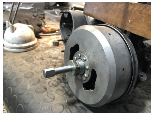
“Extracción volante magnético” imagen 72
