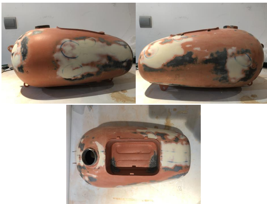
“Vistas depósito pulido de masilla” imagen 56
