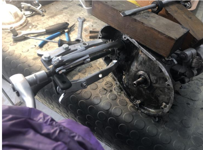
“Extracción de corona dentada con extractor de tres garras”
