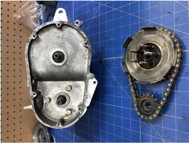
“cadena primaria y campana de embrague antes de montarse”
