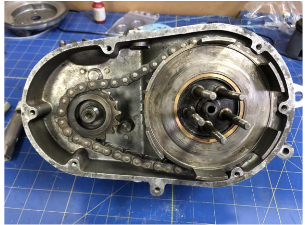
“cadena primaria y campana de embrague montadas”
