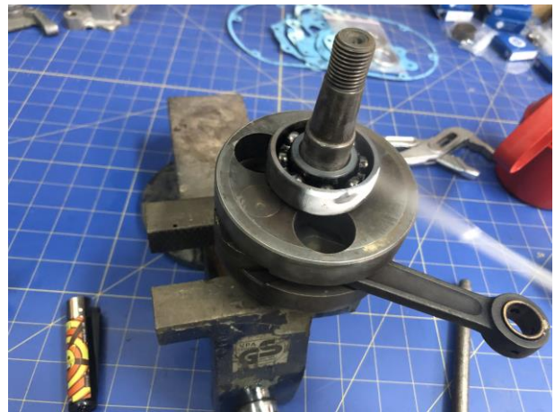
“contracción con aerosol de frío para montaje”
