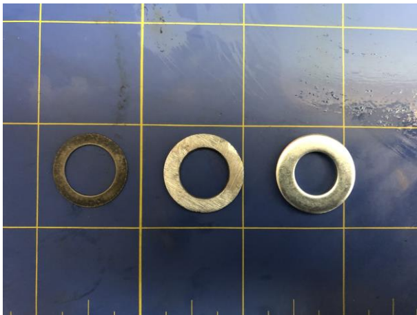
"arandela de desgaste original, fabricada y arandela base para fabricación"
