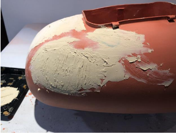
“Aplicación de masilla de poliéster” imagen
