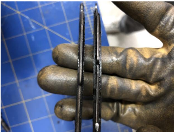
“comparación de desgaste entre discos de embrague”
