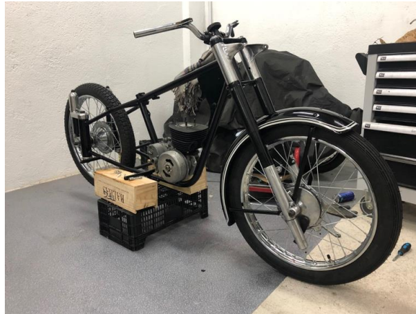
“motor y suspensiones sobre chasis”
