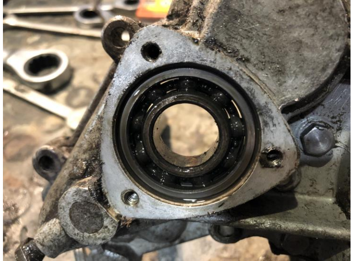
“Detalle rodamientos eje de velocidades” imagen 80
