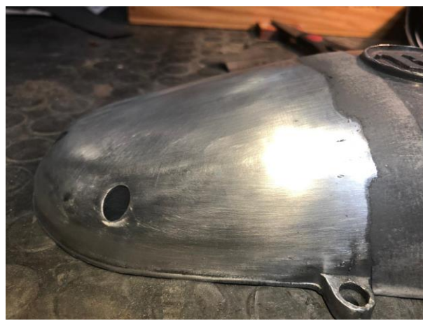
“defecto picaduras tras lija 1000” imagen 189
