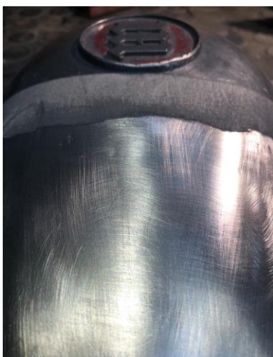
“defecto surcos tras lija 180” imagen 183
