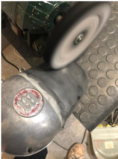
“pulido con disco de sisal y pasta azul” imagen 195
