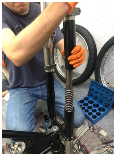
“montaje botella suspensión delantera”
