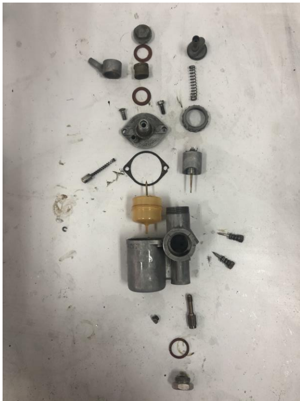
“explosión carburador previa limpieza”
