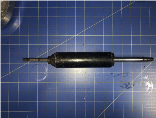
“amortiguador suspensión trasera”
