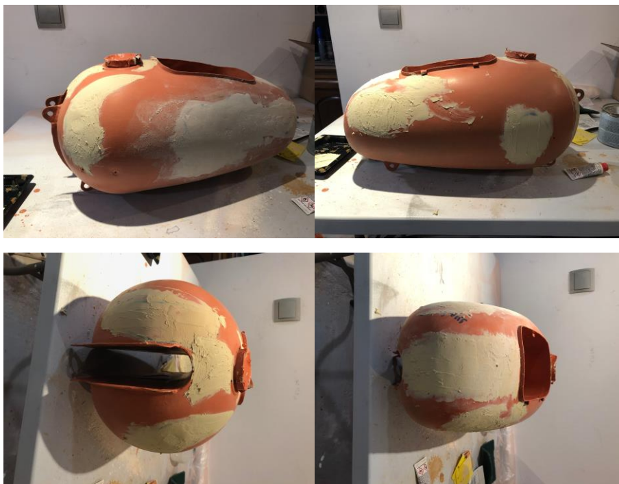
“Vistas depósito aplicación de masilla” imagen 55
