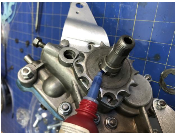
“aplicación de fijador de roscas”
