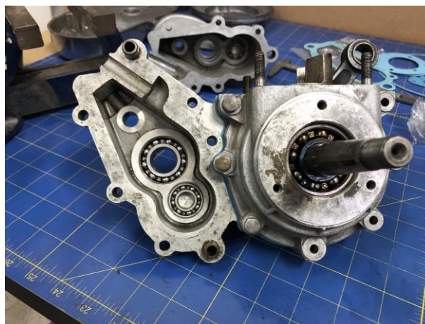
“carcasa caja de cambios previo montaje” imagen 93
