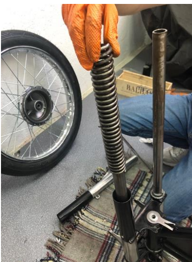
“montaje muelle suspensión delantera”
