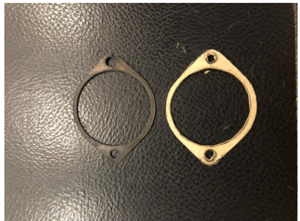
“junta original y junta fabricada”
