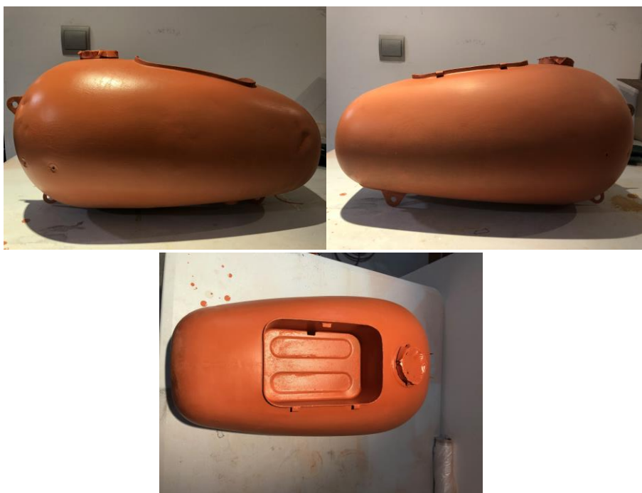
“Vistas depósito imprimación anti-óxido” imagen 53
