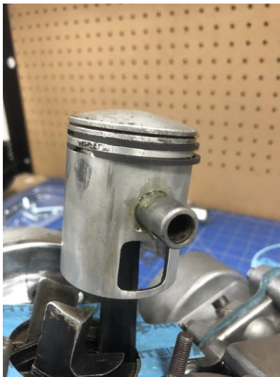
“montaje bulón en cilindro”
