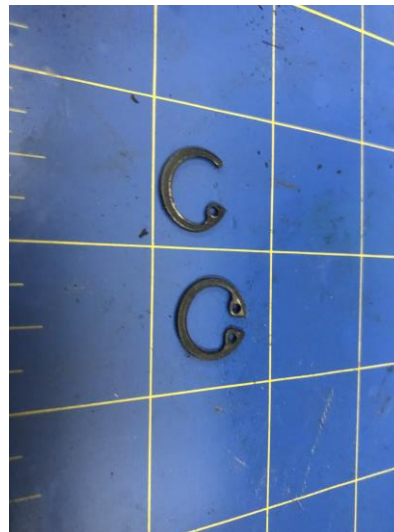
“arandelas de seguridad bulón nueva y fracturada”
