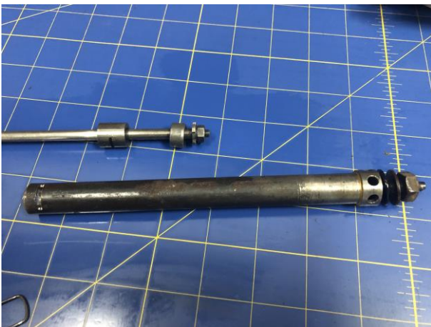
“válvula suspensión delantera”
