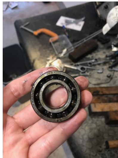
“Rodamiento carcasa caja de cambios” imagen 82
