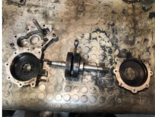
“Conjunto cámara de combustión con cigüeñal” imagen 83
