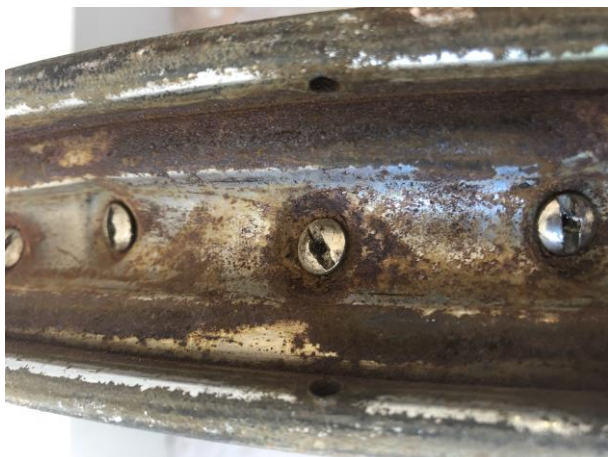
“detalle defectos paso de rueda” imagen 155
