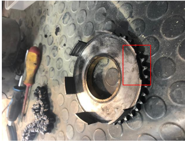
“Detalle campana de embrague fracturada”
