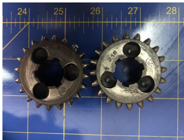
“comparación desgaste engranajes de 2ª velocidad”
