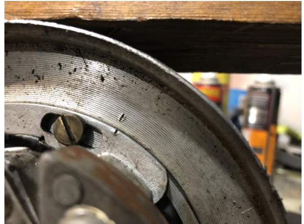
“Marca de posición plato de bobinas” imagen 74
