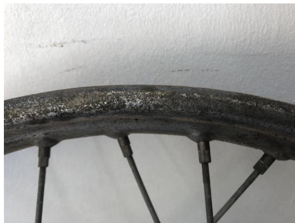
“detalle defectos llantas” imagen 156
