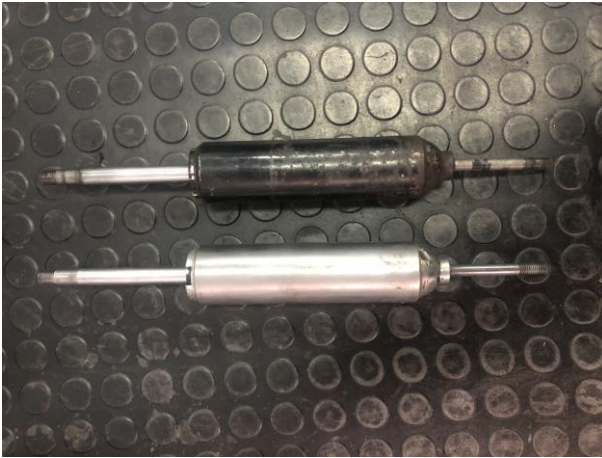
“amortiguador suspensión trasera original y decapado”
