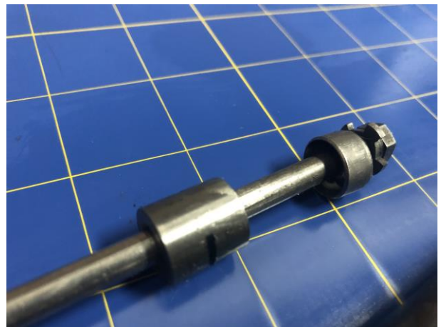
“detalle válvula suspensión delantera”
