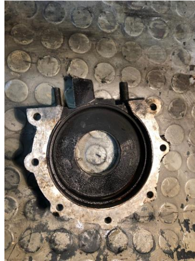
“Cámara de combustión derecha previa limpieza” imagen 84
