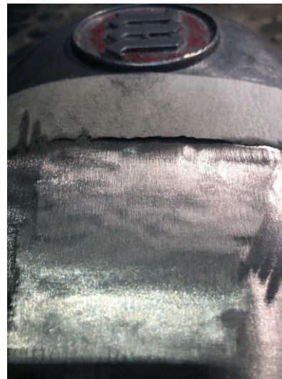
“defecto picaduras tras lija 80”
