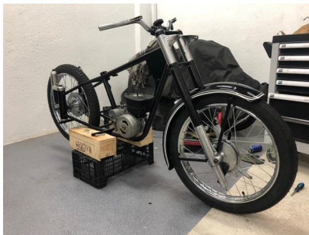
“motor y suspensiones sobre chasis”
