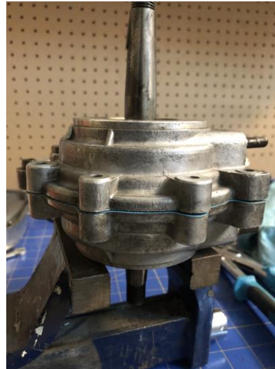
“detalle ensamble Cámara de combustión con junta correspondiente” imagen 92
