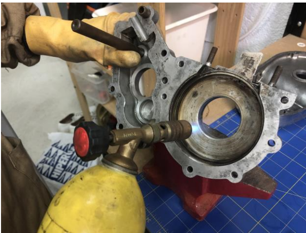
“dilatación con soplete para montaje”
