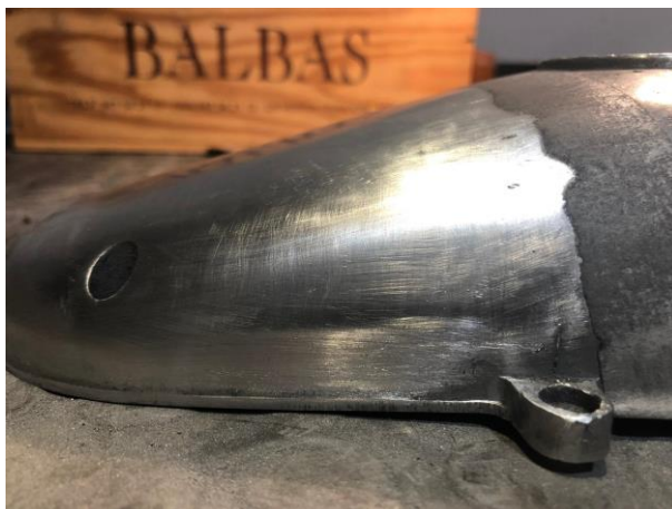
“defecto picaduras tras lija 400”
