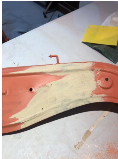
“Aplicación de masilla” imagen 34
