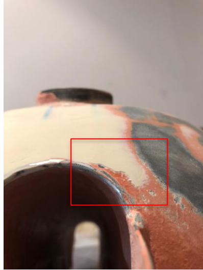
“Defecto desnivel” imagen 38
