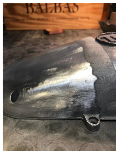
“defecto picaduras tras lija 180” imagen 184
