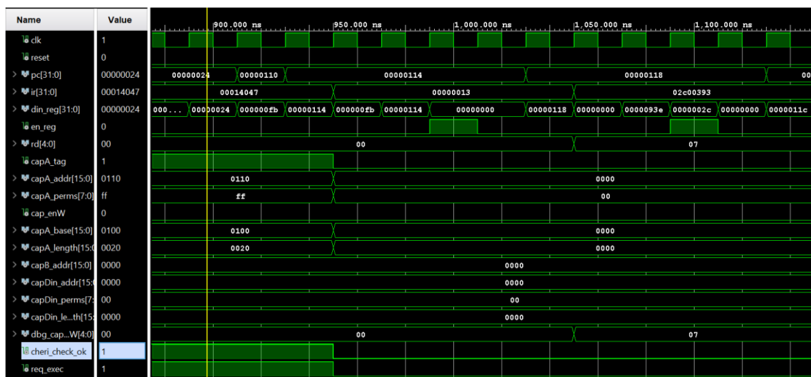
Figura 6.15: Simulación de instrucciones de transferencia de control en Vivado (2)
