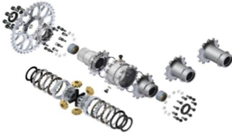
Figura 21: despiece de diferencial Drexler
