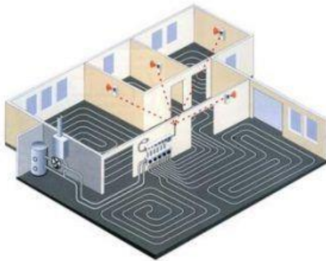
Ilustración 15: Suelo radiante en vivienda (Fuente: Consolidaciones y contratas) [9]
