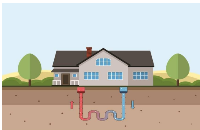
Ilustración 16: Vivienda con geotérmica de baja temperatura (Fuente: Geotermia vertical) [25]
