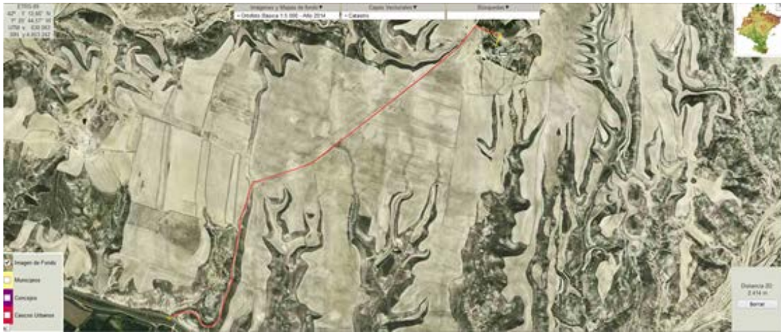
Ilustración 4: Trazado de la tubería de impulsión
