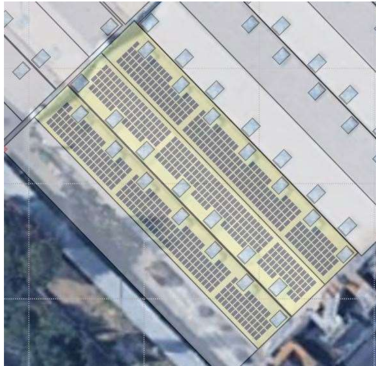
Ilustración 38. Disposición de paneles grupo 5
