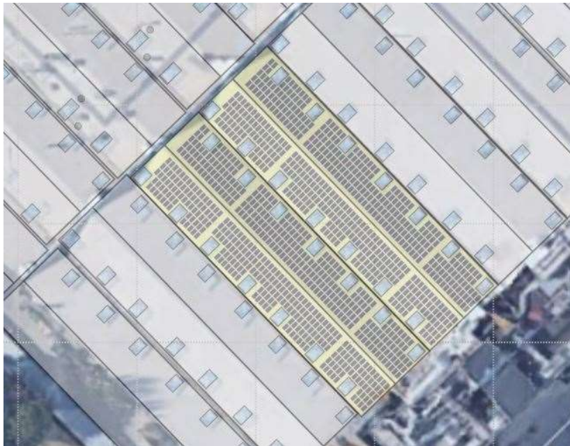
Ilustración 42. Disposición de paneles grupo 6
