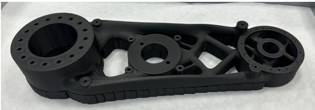
Figura 129. Pieza optimizada impresa con material de soporte (elaboración propia)
