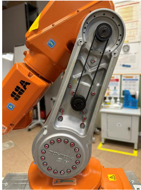
Figura 1. Brazo estructural del Link 2 (elaboración propia)
