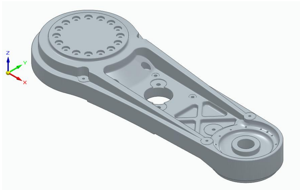
Figura 132. Link 2 creado desde cero en SolidWorks (elaboración propia)
