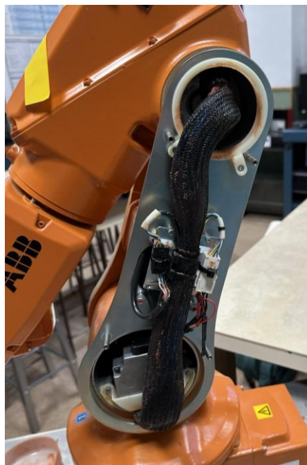
Figura 20. Cableado y electrónica en el Link 2 (elaboración propia)
