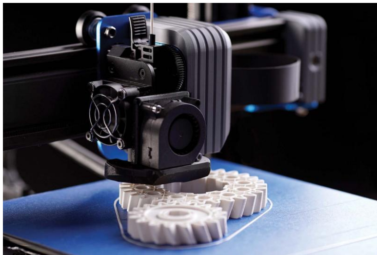
Figura 15. Ejemplo de impresión 3D de ruedas dentadas [32]
