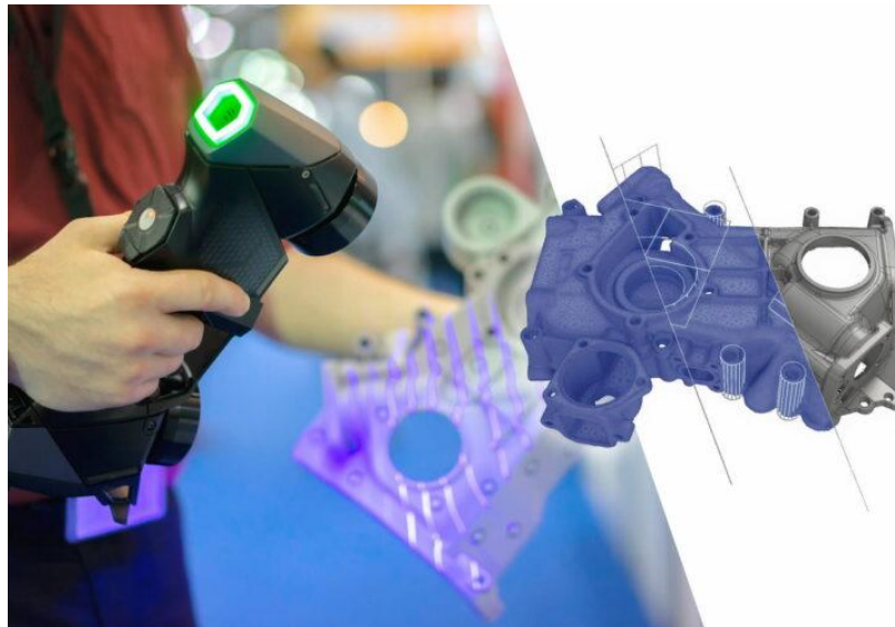
Figura 10. Escaneado 3D de un componente [21]
