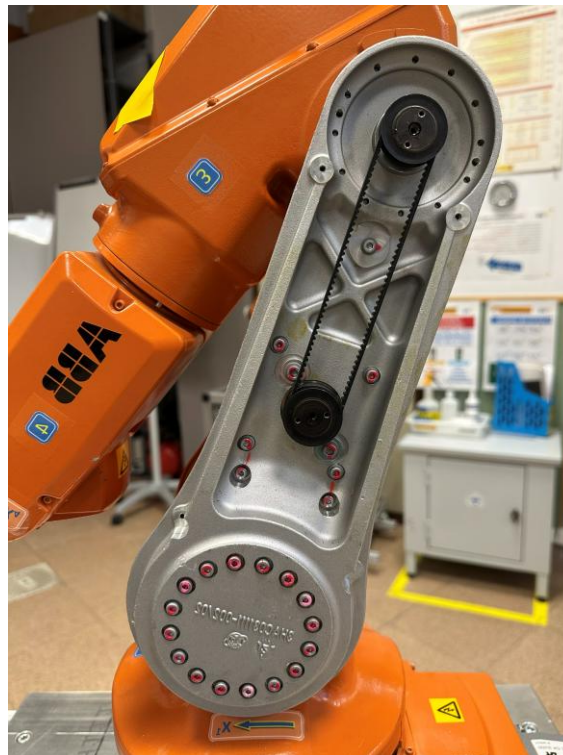
Figura 21. Brazo estructural del Link 2 (elaboración propia)
