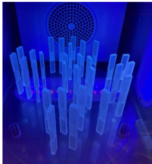
Ilustración 17: Probetas para ensayos de flexión siendo curadas
