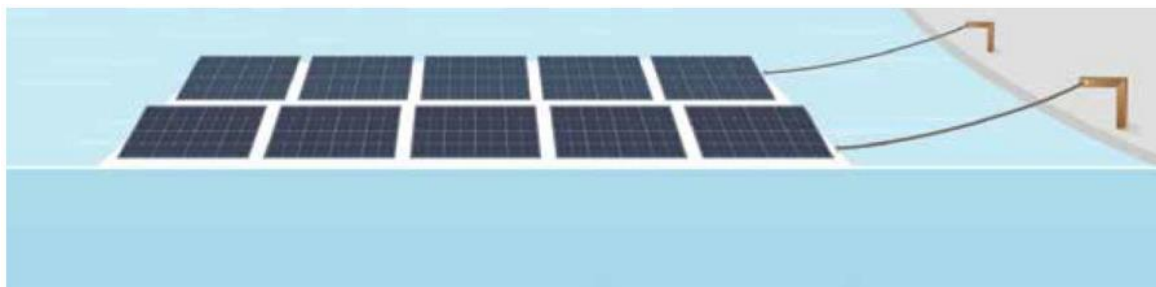
Ilustración 31: Sistema de anclaje a la orilla. Fuente: Google photos.
