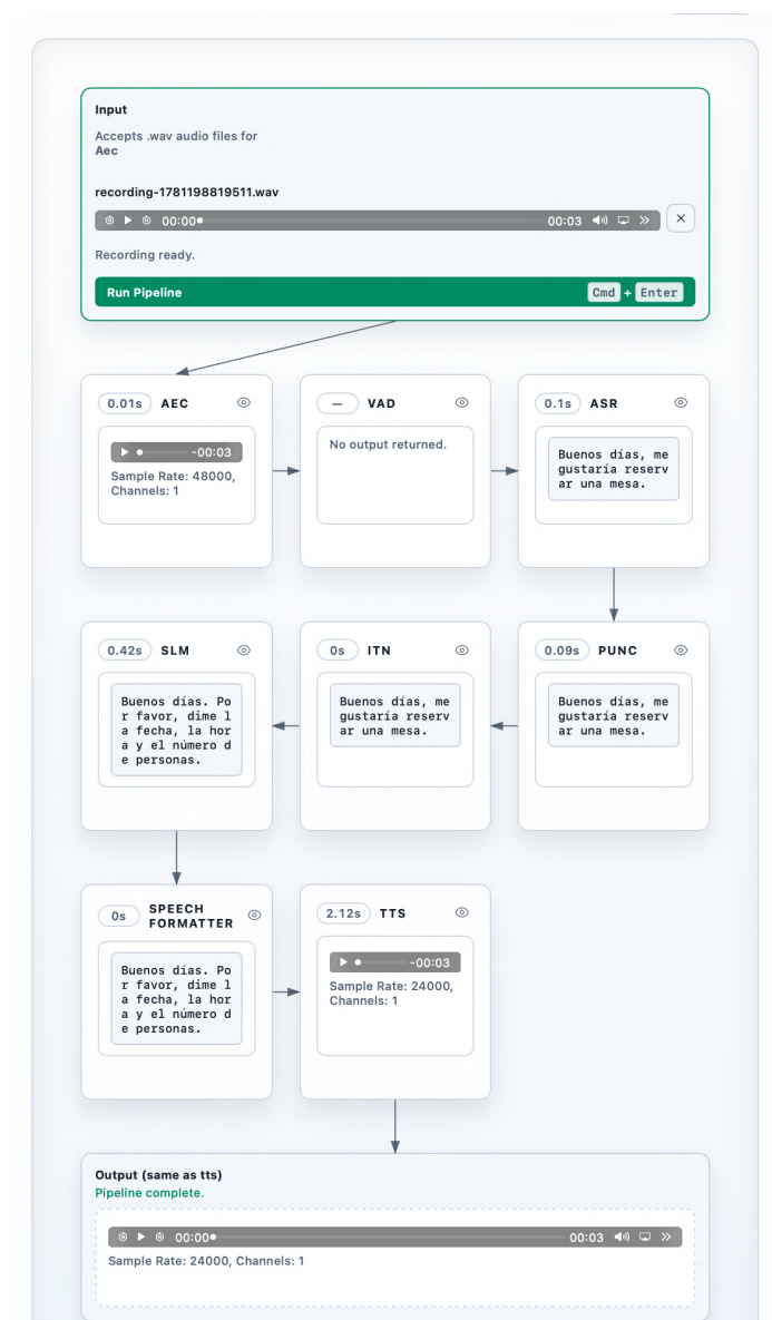
Figura 4.20: Interfaz de Laboratorio para probar el pipeline entero
