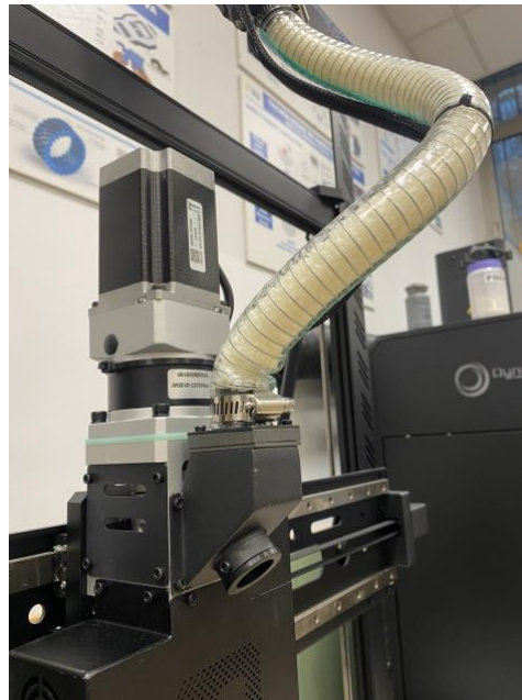
Figura 21: Compuerta que permite el intercambio de pellets de diferente material
