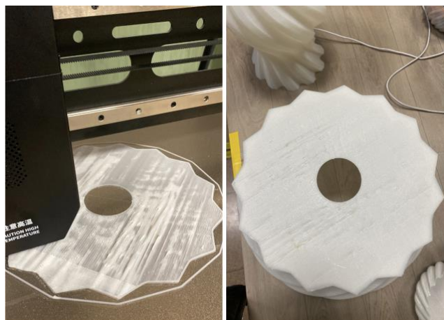
Figura 41: Problemas con la primera capa de ABS
