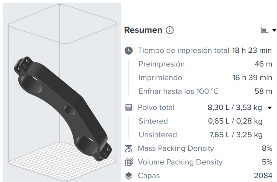
Ilustración 99: Datos de impresión en SLS de la tija original. (fuente: propia)
