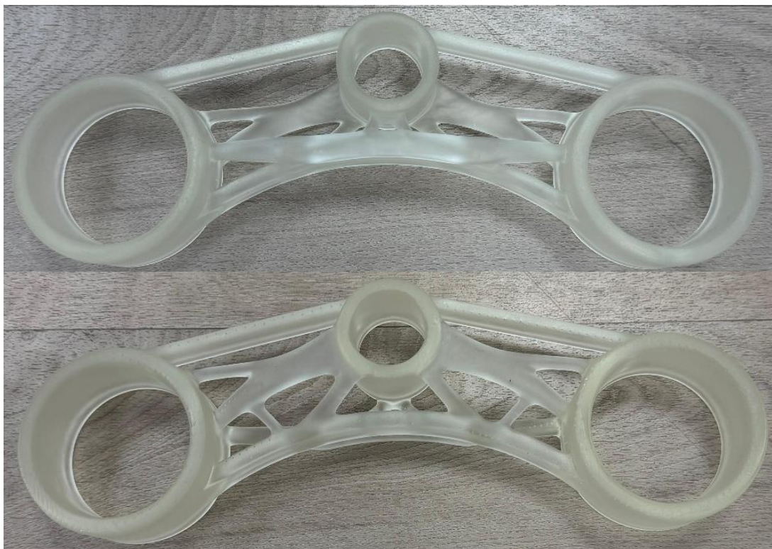
Ilustración 92: Resultado de la tija impresa en SLA. (fuente: propia)
