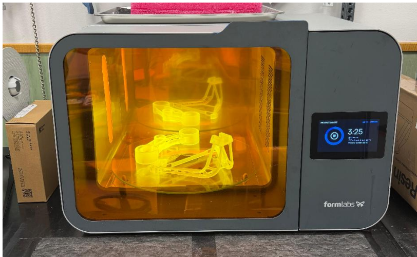
Ilustración 91: Curado de la pieza. (fuente: propia)
