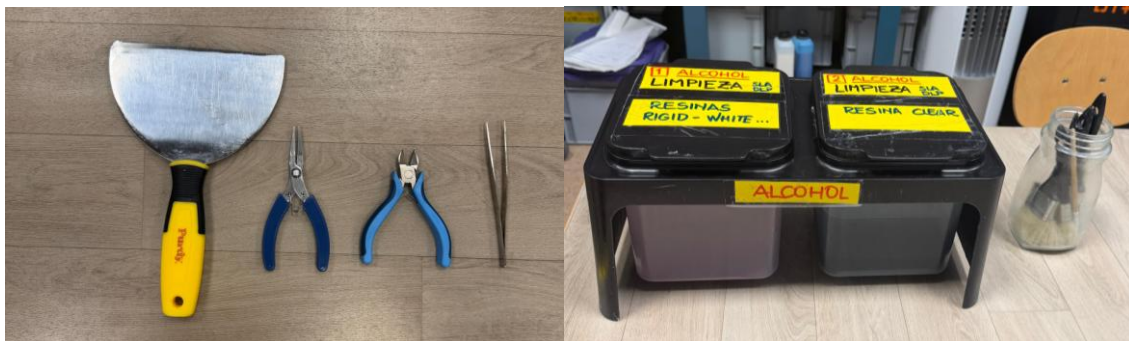
Ilustración 90: Herramientas utilizadas para el postprocesado de la tija impresa en SLA. (fuente: propia)
