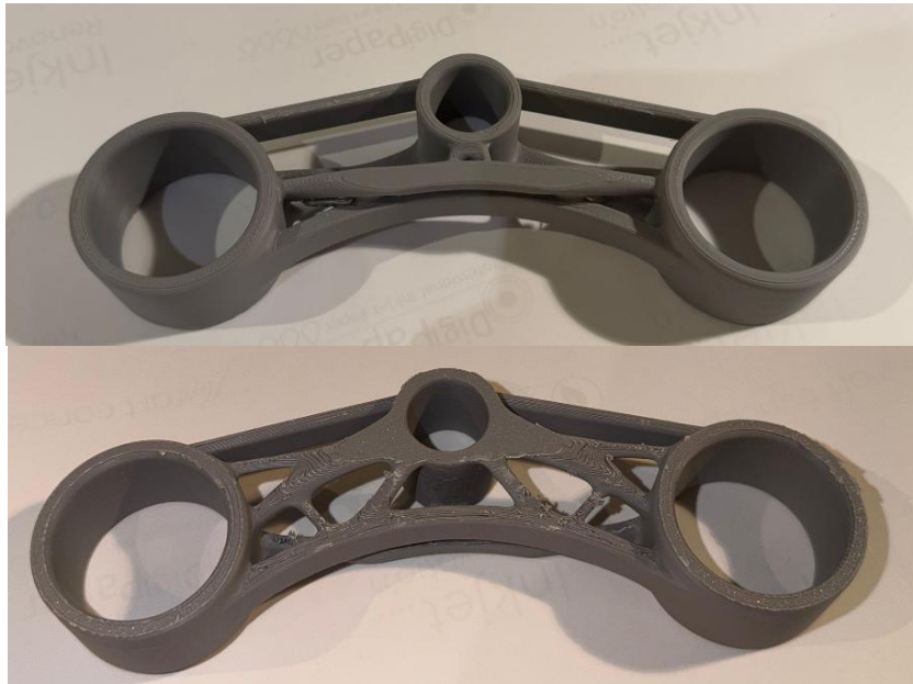
Ilustración 88: Prototipo impreso en FDM. (fuente: propia)
