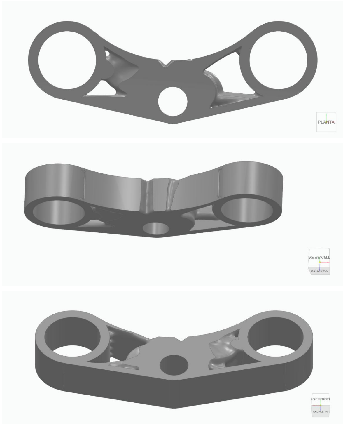
Ilustración 57: Resultado de la primera optimización topológica del prototipo 3. (fuente: propia)
