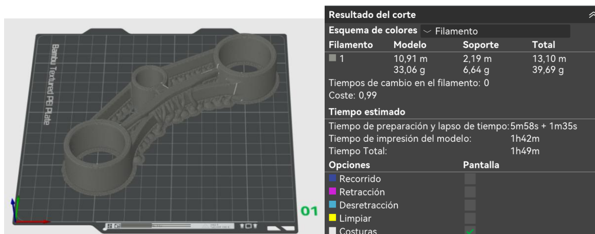
Ilustración 86: Datos de impresión en FDM del prototipo de la tija. (fuente: propia)
