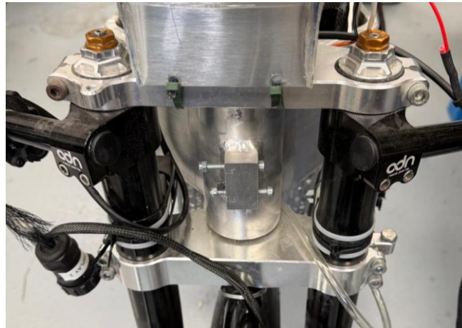
Ilustración 37: Tijas montadas sobre la moto del ISC Racing Team. (fuente: propia)
