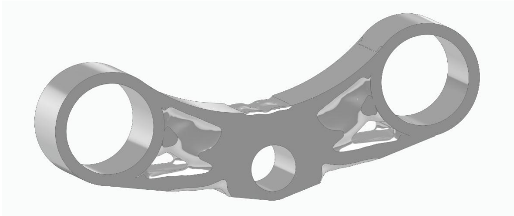
Ilustración 58: Segunda iteración de la optimización topológica del prototipo 3. (fuente: propia)
