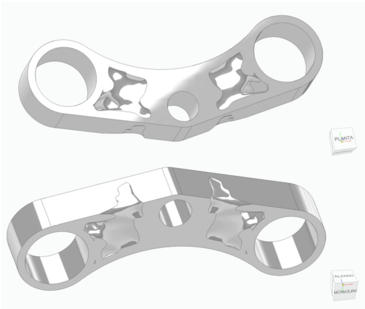
Ilustración 64: Resultado de la cuarta iteración de la optimización topológica. (fuente: propia)
