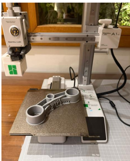
Ilustración 87: Tija impresa en FDM en la A1 mini. (fuente: propia)
