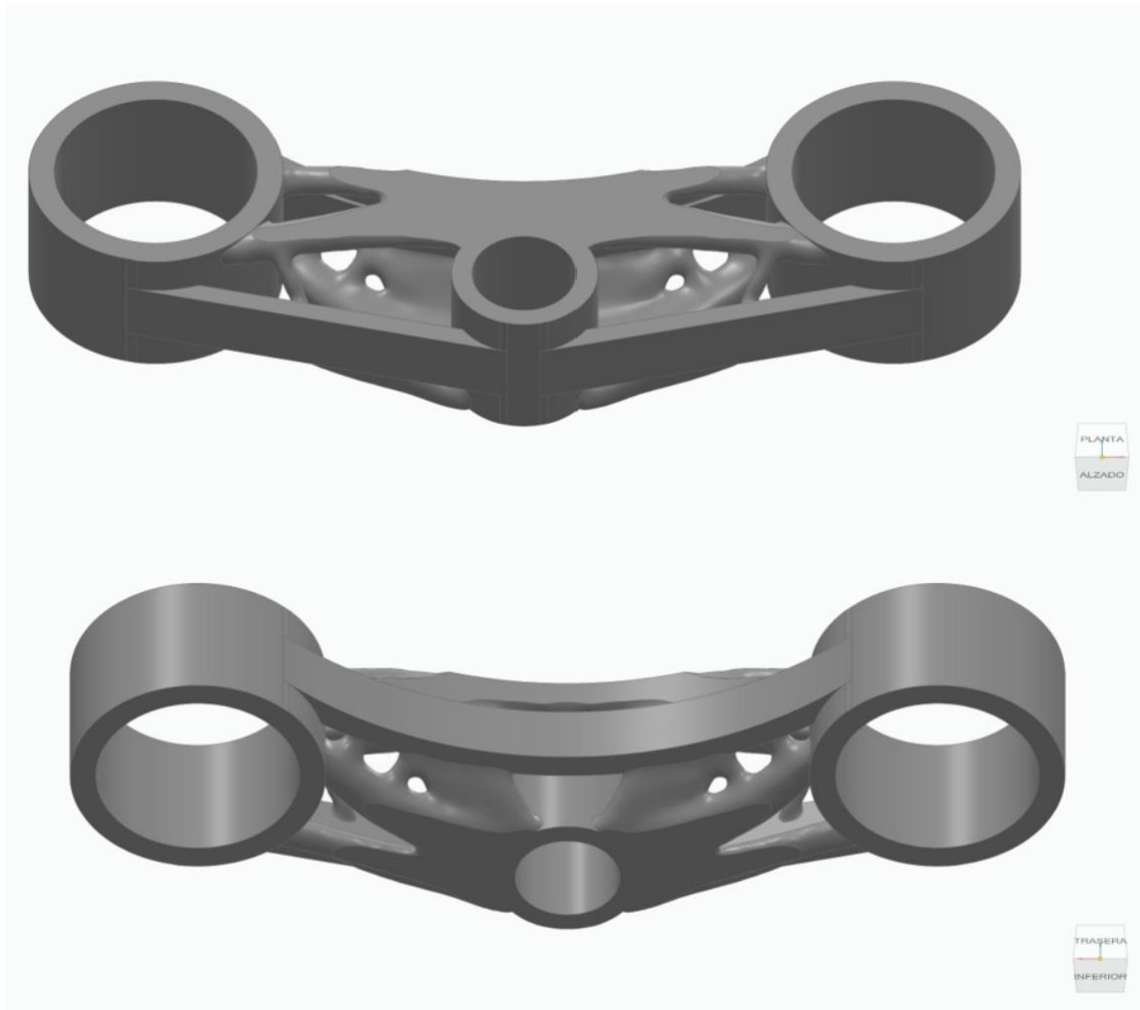
Ilustración 75: Resultado de la optimización reducida al 50%. (fuente: propia)
