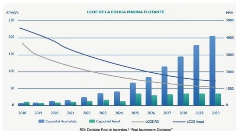
Gráfico 21. Reducción del LCOE de la eólica flotante hasta 2030. Fuente: Floating Offshore Wind Energy [WIND26].
