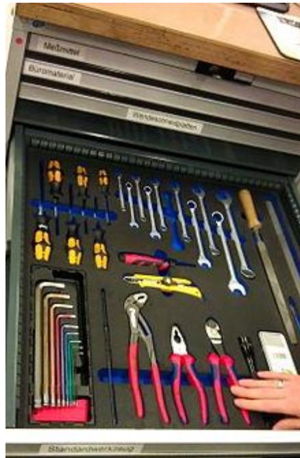
Figura 28. Cajón con siluetas para las herramientas.
