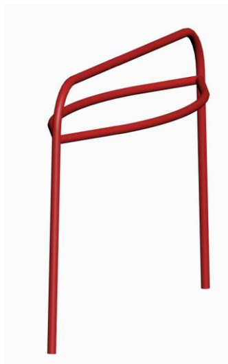
Ilustración 35: Barandilla de seguridad del balancín. Fuente: Elaboración Propia
