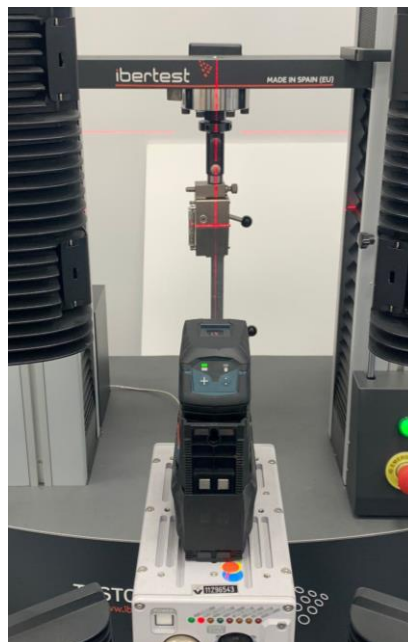
Figura 23. Comprobación de perpendicularidad
