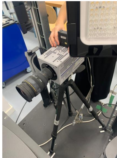
Figura 22. Nivelado de la cámara
