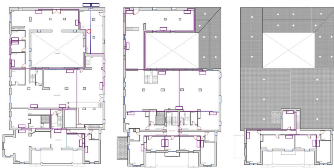
Figura 2: Planos instalación climatización
