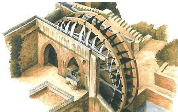
Ilustración 8: Sistema de elevación hidráulico para regadío. [18]
