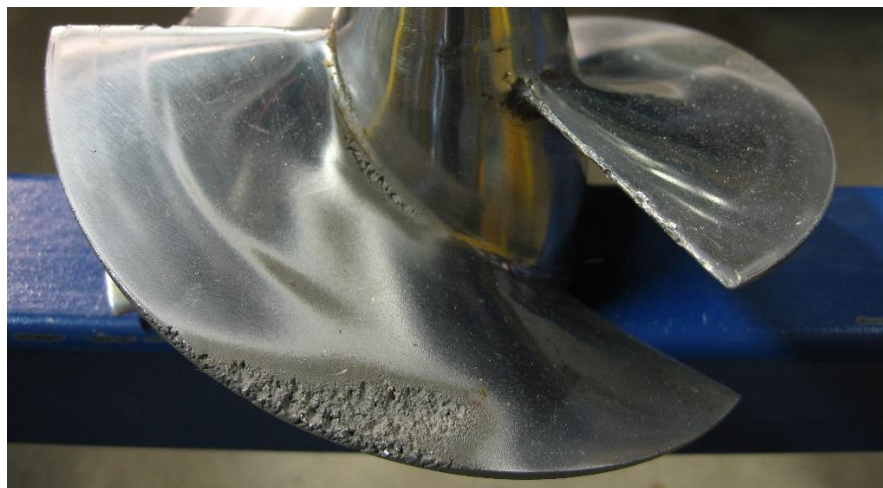
Ilustración 81: Efecto de cavitación en palas de hélice. [1 46 ]
