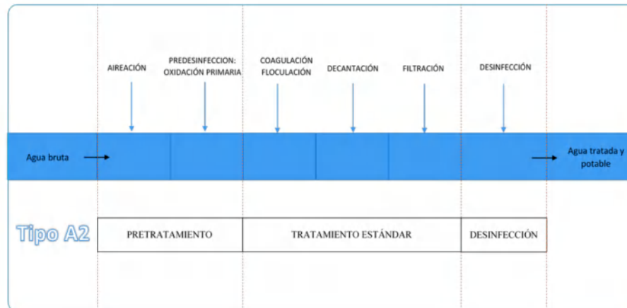
Ilustración 19. Esquema de la ETAP (Inés Valero, 2015)
