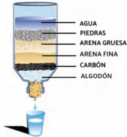
Ilustración 36. Esquema del filtro de carbón activado (Google, s.f.)
