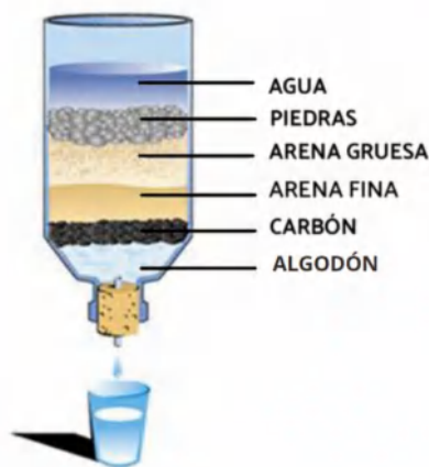
Ilustración 4. Esquema de filtro de carbón activado (Google, s.f.)
