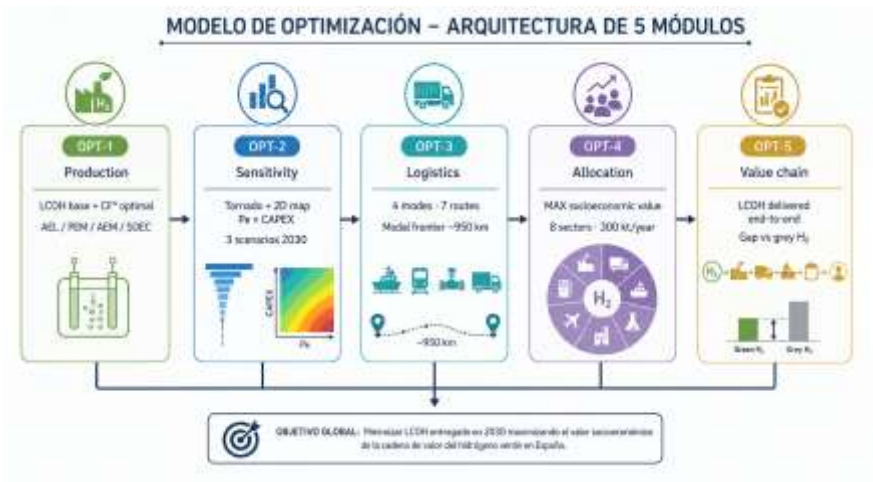
Figura 1. Arquitectura del modelo de optimización (OPT-1 a OPT-5). Todos los módulos comparten la hoja 1_INPUTS.
