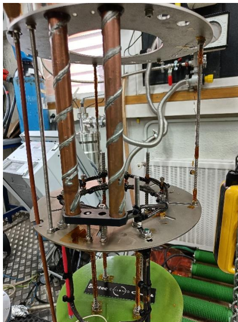
Figura 10. Criostato empleado en los experimentos.
