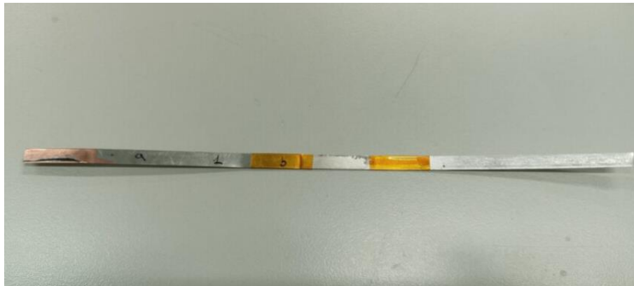
Figura 12. Imagen de la cinta superconductora.
