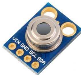
Figura 5: Módulo sensor infrarrojo de temperatura GY-906 MLX90614
