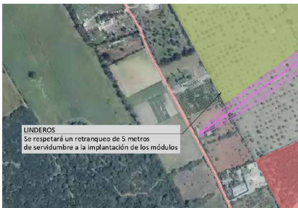
Figura 37. Servidumbre linderos. Fuente: Elaboración propia.
