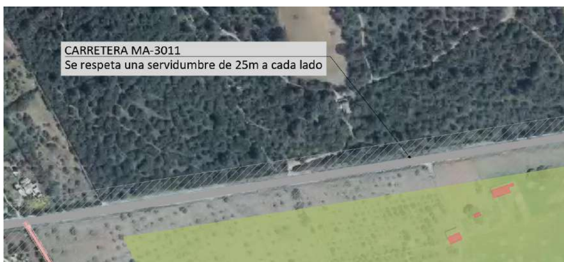
Figura 33. Servidumbre carretera MA-3011. Fuente: Elaboración propia.
