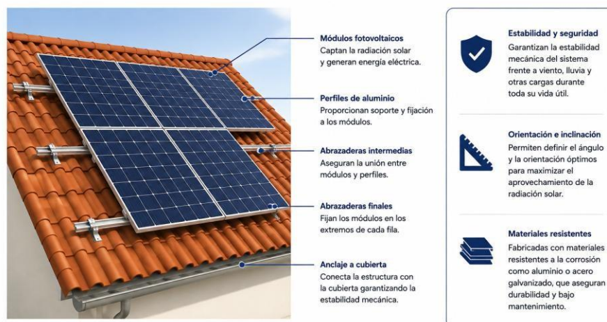
Figura 2.2.3 Estructuras de soporte
